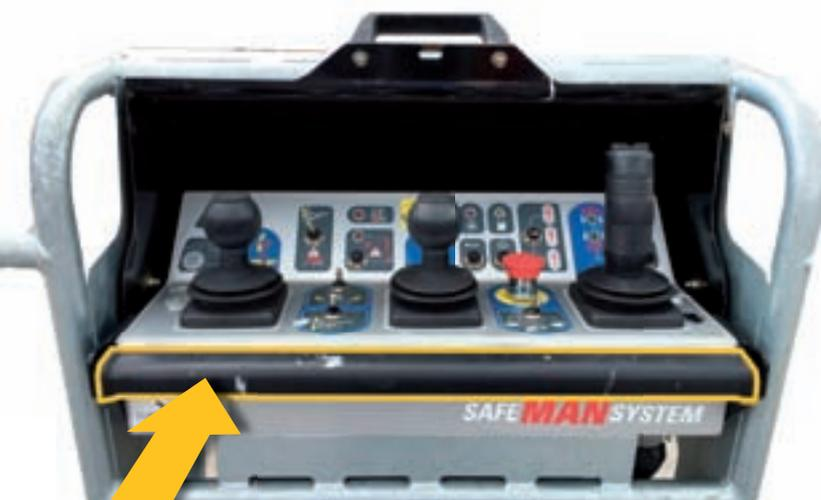
Certains sites exigent des normes de sécurité encore plus strictes, en particulier en matière d'anti-écrasement. Genie et Manitou ont mis au point un système sur leurs nacelles télescopiques. Chez Manitou, lorsque la machine est active et qu'une pression est exercée sur la barre de sécurité, une lumière bleue s'allume. L'engin doit alors être redémarré.
