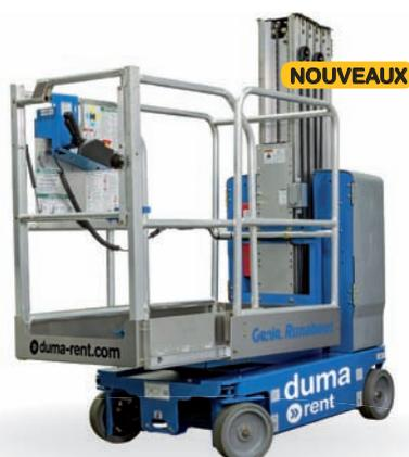
Le faible poids et la taille compacte de la nacelle à mât vertical électrique Genie GR20 vous permettront d'accéder aux endroits difficiles d'accès. Cette machine a un poids de 1112 kg et une largeur de 0,80m. Elle est équipée de pneus non marquants et ne laisse donc aucune trace sur les sols. Idéale pour travailler dans les entrepôts logistiques, procéder au nettoyage de vitres, d'un atrium de bâtiment professionnel ou l'entretien dans les salles de sport.
