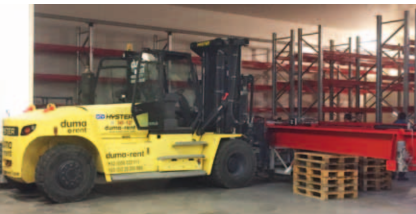
Montage magazijnpicker @Tielt / HYSTER H16 XM-1200
