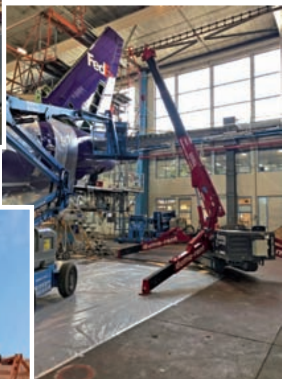
UNIC URW-506 & 2x Genie Z45 JDC gros entretien d'un Boeing 737 @Zaventem
