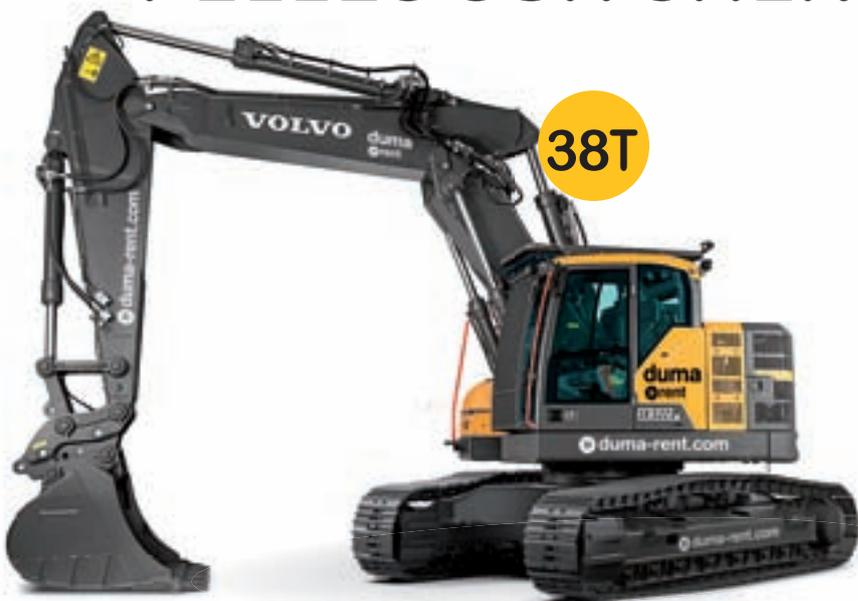
Cette pelle sur chenilles Volvo a un bras en trois parties (triple flèche) pour pouvoir être utilisée dans des endroits difficilement accessibles.
