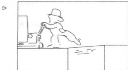
Voordat met de truck over een laadplatform wordt gereden, dient de bestuurder eerst te controleren of het platform goed vastzit en of het het noodzakelijke draagvermogen heeft. Rijd traag en voorzichtig over het laadplatform en rijd steeds op een veilige afstand van de rand.
