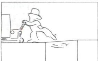
Avant d'engager le chariot sur une rampe de chargement, s'assurer que cette dernière est correctement fixée et offre une capacité de charge suffisante. Conduire lentement et faire preuve de prudence sur la rampe, en maintenant une distance de sécurité par rapport aux bords de la rampe.
