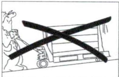
Lors d'une utilisation du chariot sur une pente, la charge devra toujours être dirigée vers le bas de celle-ci et le chariot devra toujours être conduit avec une précaution accrue.
