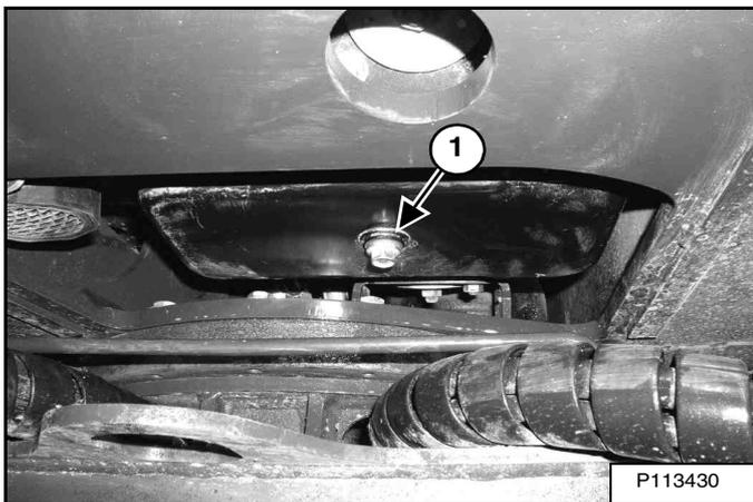
Placez un récipient sous le carter d'huile. Retirez le bouchon de vidange (1) [Figure 175] situé au fond du carter d'huile moteur.
