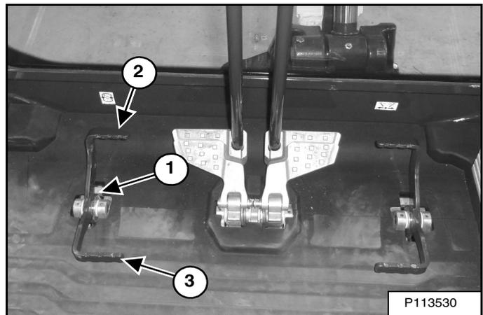
Appuyez sur l'avant de la pédale (2) [Figure 46] pour alimenter le raccord rapide femelle (selon modèle) en débit et pression hydrauliques.
