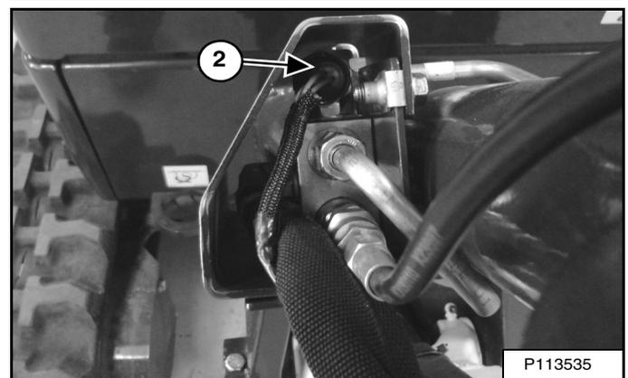
Appuyez sur la gauche du contacteur (1) pour activer le contacteur de pression (2) [Figure 68] prévu en option dans le clapet de maintien de charge de la flèche.
