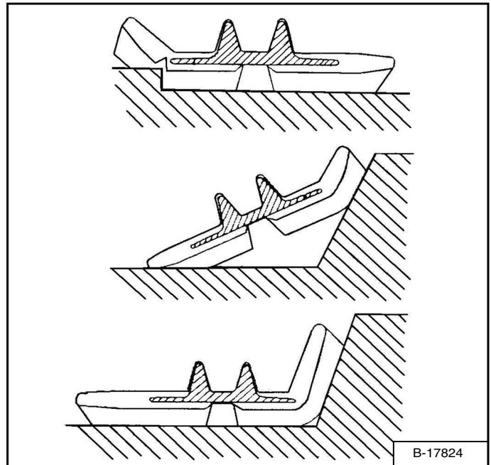
Lorsque les chenilles en caoutchouc passent sur des arêtes ou des rebords, une contrainte extrême est exercée sur l'enveloppe en caoutchouc, en particulier au niveau des bords des inserts métalliques, entraînant des fissures et des entailles dans cette zone [Figure 142].
