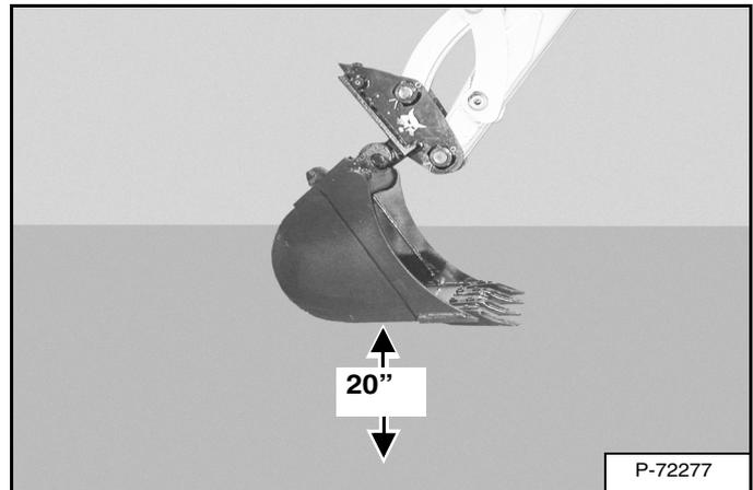
Levez la flèche jusqu'à obtenir un écart d'environ 20,0" (500 mm) entre le bas de l'accessoire et le sol [Figure 105].
