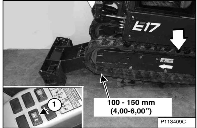
Déplacez le contacteur de commande de la lame / d'écartement et de rapprochement des chenilles (1) [Figure 52] vers la droite en position lame.
