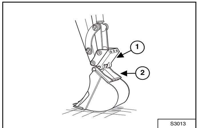
Abaissez l'attache rapide Bobcat (1) sur l'adaptateur (2) [Figure 91] du godet.
