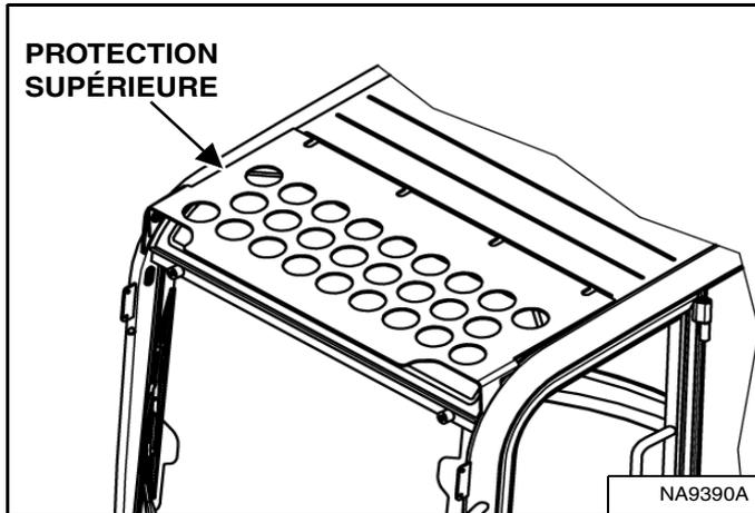
Disponible pour les applications spéciales exigeant une protection contre la chute de petits objets sur le toit / le canopy ou la pénétration de matériaux par les ouvertures du canopy / de la cabine [Figure 5] et [Figure 6].
