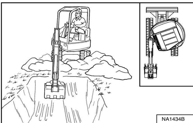
En faisant pivoter la tourelle et en déportant la flèche vers la droite [Figure 127], le centre [Figure 128] et la gauche [Figure 129], il est possible de creuser un trou carré de la largeur de la machine sans devoir la repositionner.
