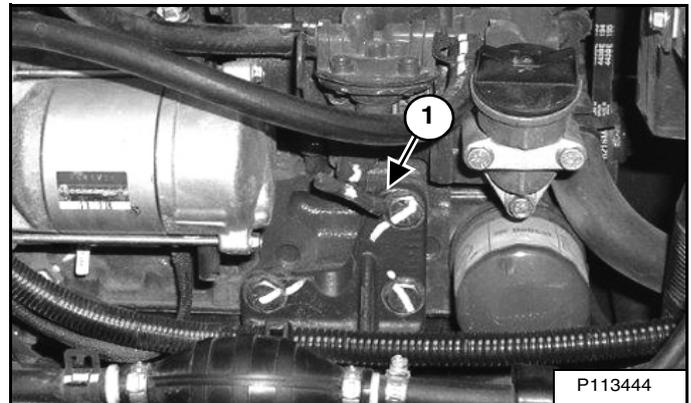
Posez un flexible sur le robinet de vidange situé à l'arrière du bloc moteur, à la base du démarreur. Ouvrez le robinet de vidange (1) [Figure 181] et vidangez le liquide de refroidissement dans un récipient.
