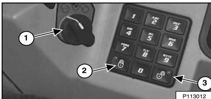
Appuyez sur les touches de verrouillage (2) et de déverrouillage (3) [Figure 222] pendant 2 secondes.
