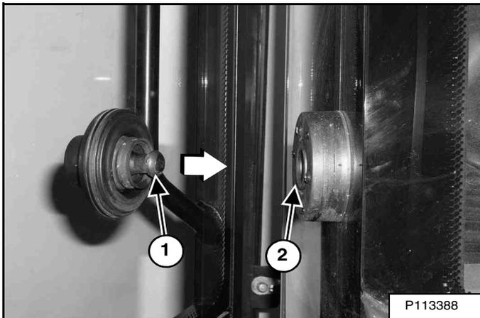
Pour verrouiller la porte en position ouverte, ouvrez-la complètement en la poussant jusqu'à ce que la butée (1) s'engage dans le verrou (2) [Figure 16].
