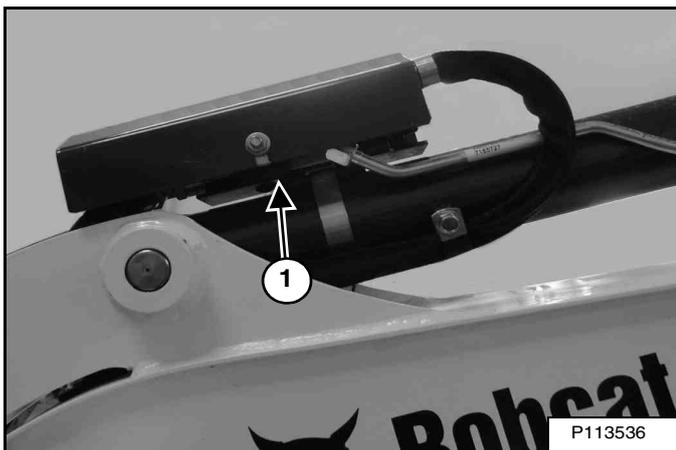
Si la pelle compacte est équipée d'un clapet de maintien de charge du balancier (1) [Figure 64], celui-ci est monté à l'extrémité base du vérin de balancier, comme illustré.
