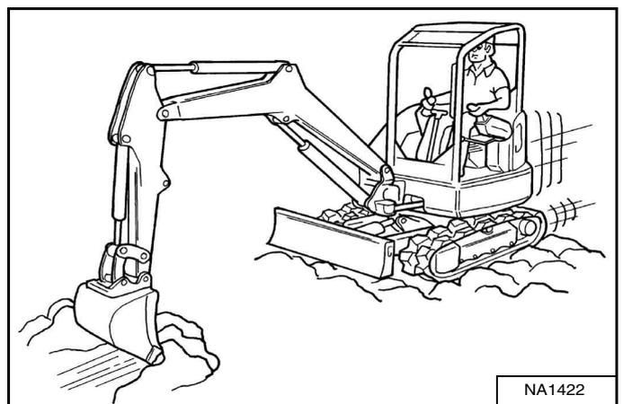
Le godet peut également être utilisé pour tirer la pelle compacte. Levez la lame, étendez le balancier et abaissez la flèche. Utilisez la flèche et le balancier comme pour une excavation [Figure 133].
