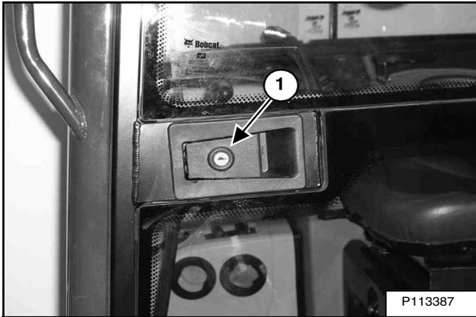
La porte de la cabine (1) se verrouille [Figure 15] à l'aide de la clé de contact. Tirez sur le loquet pour ouvrir la porte.
