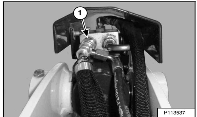
**REMARQUE :** NE retirez PAS et N'ajustez PAS le clapet de sécurité secondaire (1) [Figure 65] (relié au flexible de vidange). Si le clapet de sécurité secondaire a été altéré, faites contrôler la machine par votre concessionnaire Bobcat.
