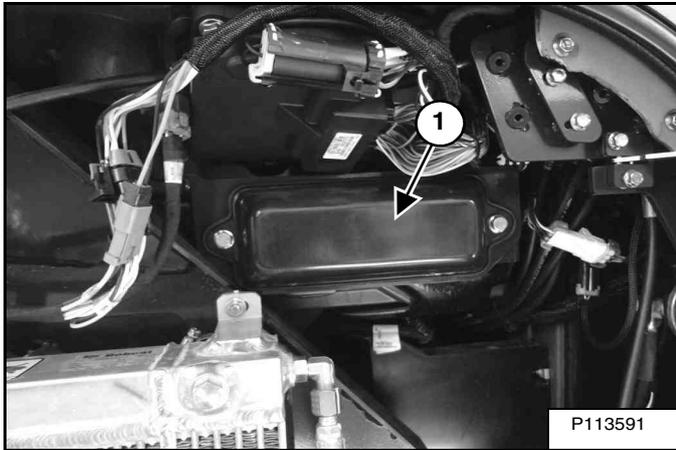
La pelle compacte est alimentée par un système électrique 12 V à masse négative. Le système électrique est protégé par des fusibles qui se trouvent sous le capot latéral droit de la pelle compacte (1) [Figure 182]. Les fusibles protègent le système électrique contre les surcharges. La cause de toute surcharge doit être identifiée et corrigée avant de remettre le moteur en marche.
