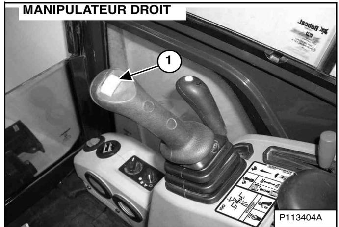
Si la machine est équipée du contacteur sur le manipulateur droit, déplacez le contacteur (1) [Figure 119] vers la droite pour ouvrir la pince. Déplacez le contacteur vers la gauche pour fermer la pince.
