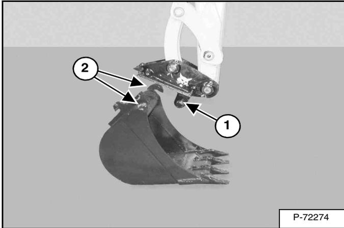
Assurez-vous que l'attache rapide n'est pas usée ou endommagée. Assurez-vous que les broches de l'attache rapide (1) et les crochets (2) de l'accessoire [Figure 112] ne sont pas usés ou endommagés.
