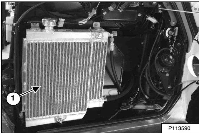
Nettoyez le radiateur / refroidisseur d'huile (1) [Figure 177] (surfaces internes et externes) à l'aide d'air ou d'eau à basse pression. Veillez à ne pas endommager les ailettes pendant le nettoyage.
