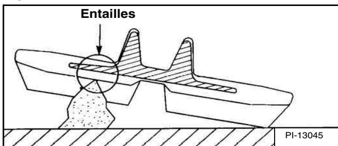
Lorsque les chenilles en caoutchouc passent sur des pointes ou des arêtes tranchantes, les forces concentrées appliquées peuvent entailler l'enveloppe en caoutchouc [Figure 141]. En cas de virage sur une pointe ou une arête, le risque d'entailles est encore accru. Si les entailles parviennent jusqu'aux câbles en acier intégrés, elles peuvent entraîner leur rupture par corrosion.
