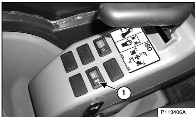
Déplacez le contacteur de commande de la lame / d'écartement et de rapprochement des chenilles (1) [Figure 54] en position Rapprochement et écartement des chenilles.
