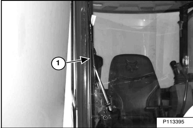
Le pare-brise avant est équipé d'un essuie-glace (1) [Figure 23] et d'un lave-glace.
