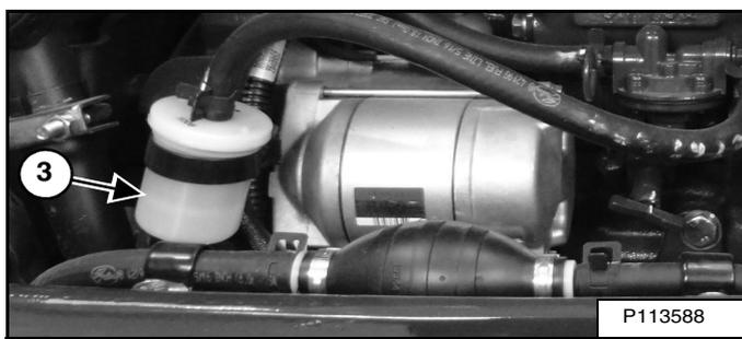
Desserrez le robinet de purge (1) [Figure 168] situé au bas du filtre pour purger l'eau du filtre dans un récipient.
