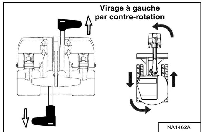
Poussez le levier de direction droit vers l'avant et tirez le levier de direction gauche vers l'arrière [Figure 38].
