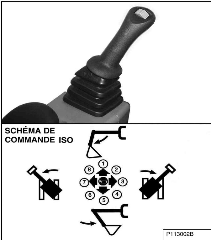
Le manipulateur gauche permet de commander le balancier et l'orientation de la tourelle [Figure 39].
