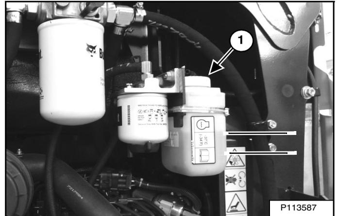
Contrôlez le niveau de liquide de refroidissement dans le vase d'expansion (1) [Figure 178].
