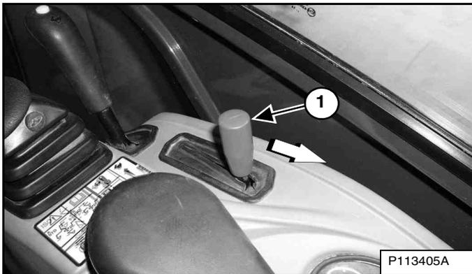
Tirez le levier d'accélérateur (1) [Figure 87] vers l'arrière en position de ralenti.
