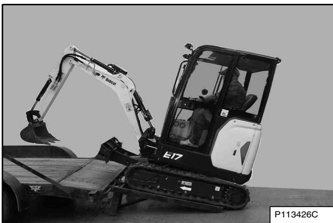
Faites monter la machine en marche avant sur la remorque [Figure 146].
