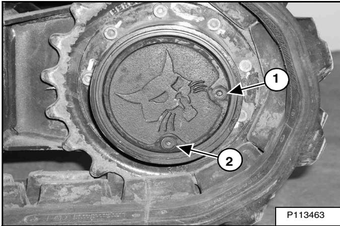
Garez la pelle compacte sur une surface plane et de niveau avec les bouchons (1 et 2) [Figure 206] dans la position indiquée.
