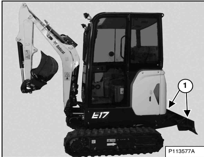
Étendez complètement les vérins du godet, du balancier et de la flèche de façon à positionner la pelle compacte comme illustré sur la [Figure 143].
