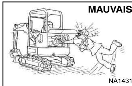
⚠ Maintenez le corps, les bijoux et les vêtements à l'écart des pièces mobiles, des contacts électriques, des pièces brûlantes et de l'échappement.
