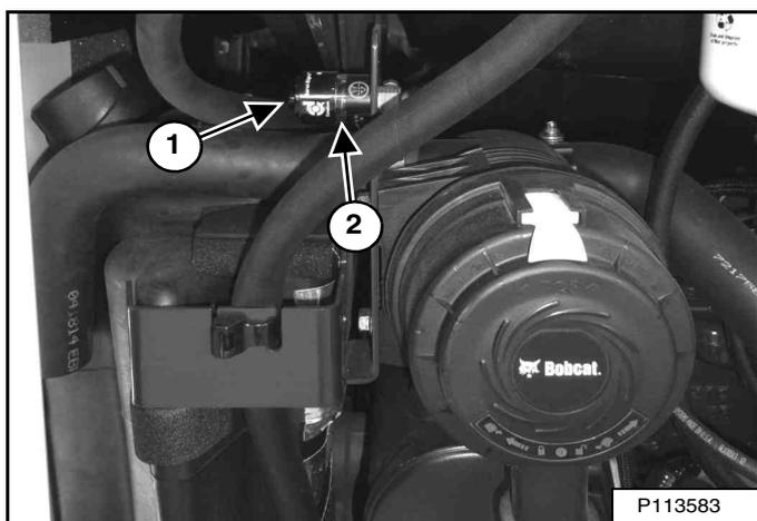
Contrôlez l'indicateur de colmatage (1). Si l'anneau de couleur rouge (2) [Figure 162] apparaît dans l'indicateur de colmatage, cela signifie que le filtre doit être remplacé.
