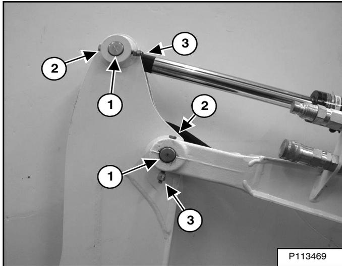
Les pivots et les vérins (1) comportent un grand axe maintenu en position par une vis (2) et deux écrous (3) [Figure 220].
