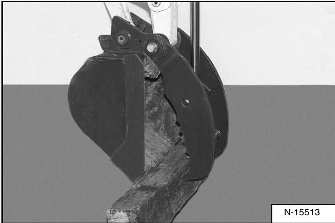
La pince hydraulique en option augmente les possibilités d'utilisation de la pelle compacte ainsi que son efficacité pour le ramassage des débris [Figure 118].
