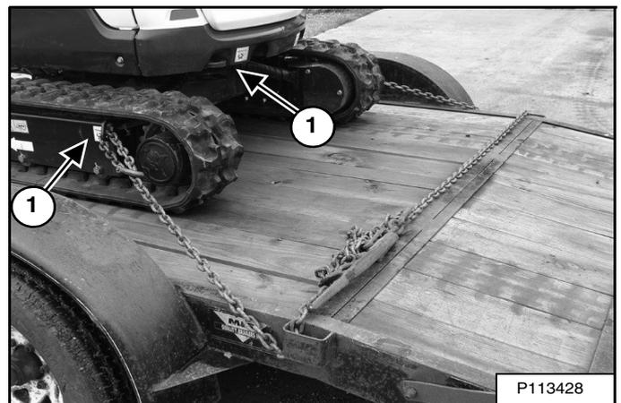
Fixez des chaînes aux coins avant de la lame (1) [Figure 147] (ou au coin avant de la tourelle) et aux points d'arrimage des bâtis des deux côtés du bâti de chenille (1) [Figure 148] (ou au point d'arrimage à l'arrière de la tourelle) pour empêcher la machine de bouger lorsque le véhicule de transport monte ou descend une pente ou en cas d'arrêt brutal.
