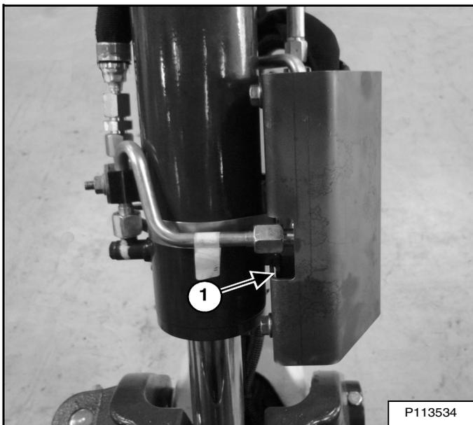
Si la pelle compacte est équipée d'un clapet de maintien de charge de la flèche (1) [Figure 60], celui-ci est monté sur le vérin de flèche, côté tige.
