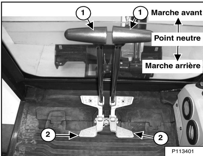
Positionnez la lame à l'avant de la machine (vue du siège de l'opérateur). Déplacez lentement les deux leviers de direction\* (1) [Figure 32] vers l'avant pour déplacer la pelle en marche avant ou vers l'arrière pour la déplacer en marche arrière.
