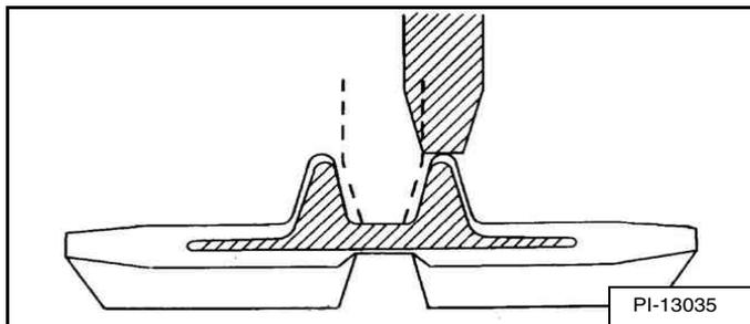
Tension des chenilles incorrecte : lorsque les chenilles en caoutchouc ne sont pas suffisamment tendues, la roue de tension ou le barbotin passe sur les crampons de guidage et dénude les inserts métalliques [Figure 140], ce qui entraîne la corrosion de ces derniers (reportez-vous à TENSION DES CHENILLES, page 134).
