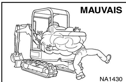
⚠ Arrêtez le moteur, laissez-le refroidir et éliminez tous les matériaux inflammables du moteur avant de contrôler les niveaux.
