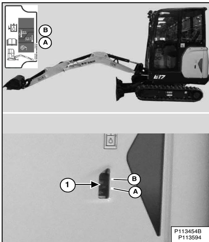
Garez la machine dans la position indiquée [Figure 193]. (Contrôlez de préférence l'huile hydraulique lorsqu'elle est froide.)
