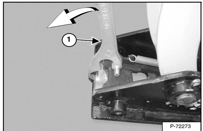
Pour déverrouiller l'attache rapide, engagez l'outil (1) [Figure 101] et tirez sur la poignée. Le verrou doit avancer entièrement. Le verrou se bloque en position déverrouillée.
