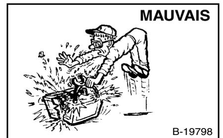
⚠ Les batteries au plomb dégagent des gaz inflammables et explosifs.
