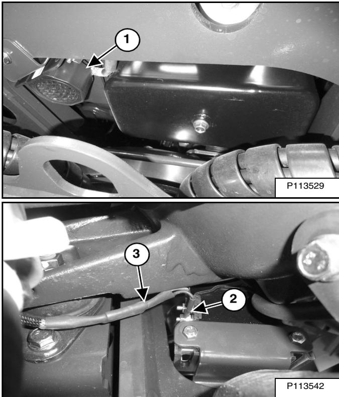
L'avertisseur de déplacement (1) [Figure 153] se situe en bas à l'arrière de la pelle compacte (à côté du carter d'huile moteur).
