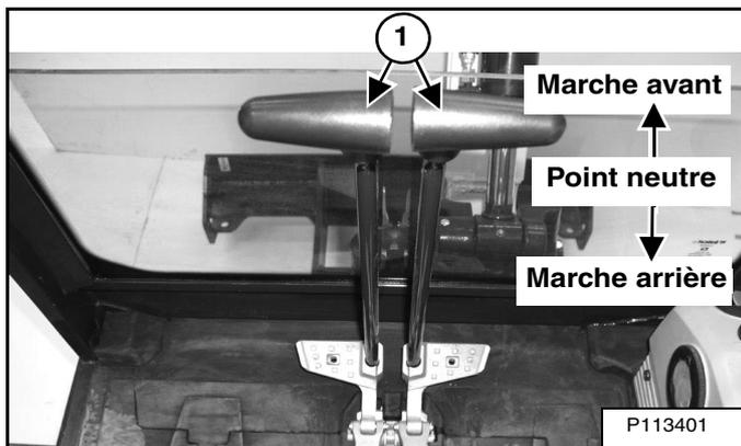
Placez les leviers de direction (1) [Figure 79] au point NEUTRE.
