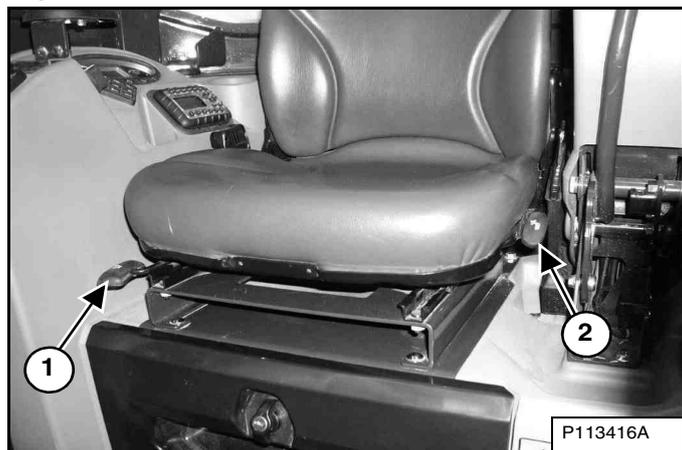
Libérez le levier du siège (1) [Figure 74] pour avancer ou reculer le siège.
