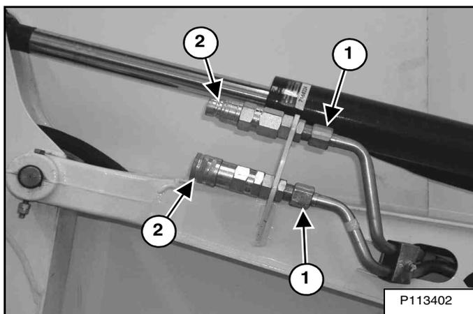
La pelle compacte est équipée de conduites hydrauliques (1) [Figure 41] pour alimenter les accessoires en huile hydraulique.
