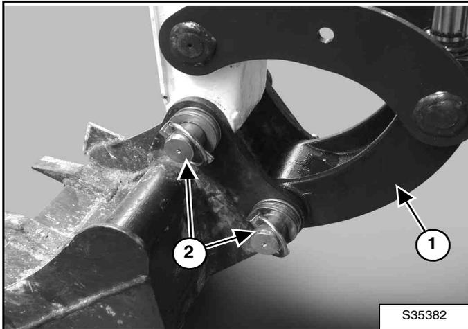
Vérifiez que l'articulation du godet (1) n'est pas usée ou endommagée. Vérifiez que les broches de l'accessoire (2) [Figure 209] ne sont pas usées ou endommagées.
