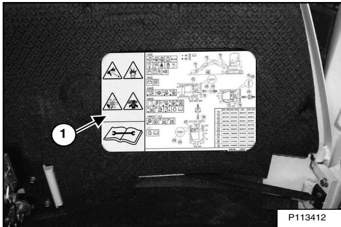
Les entretiens doivent être effectués à intervalles réguliers afin d'éviter toute usure excessive ou défaillance prématurée des composants de la machine. Utilisez le tableau d'entretien comme référence lors de toute opération d'entretien de la pelle compacte Bobcat. L'autocollant de sécurité (1) [Figure 69] se situe à l'intérieur de la porte arrière (reportez-vous à TABLEAU D'ENTRETIEN, page 103).
