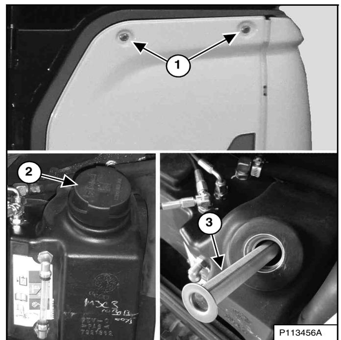
Retirez les deux vis (1) [Figure 194] au sommet du capot latéral gauche et retirez le capot.
