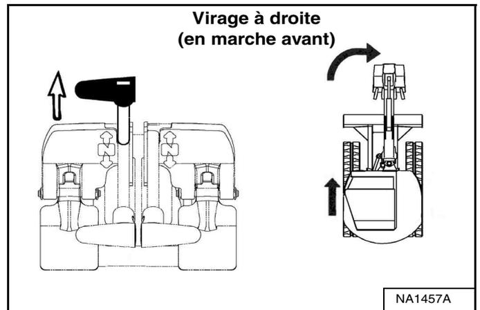
Poussez le levier de direction gauche vers l'avant pour tourner à droite [Figure 33] en marche avant.
