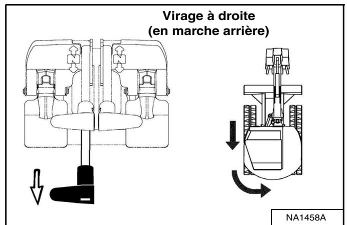
Tirez le levier de direction gauche vers l'arrière pour tourner à droite en marche arrière [Figure 34].
