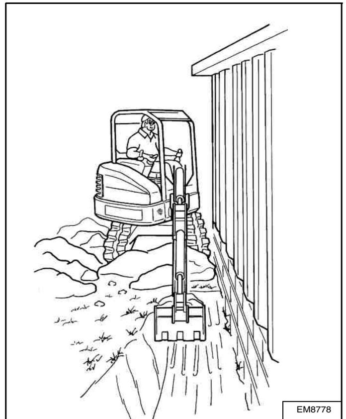
Le déport de flèche permet également de creuser au plus près d'un bâtiment ou de toute autre structure [Figure 130].
