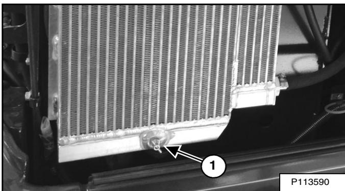
Posez un flexible sur le robinet de vidange situé au bas du radiateur. Ouvrez le robinet de vidange (1) [Figure 180] et vidangez le liquide de refroidissement dans un récipient.
