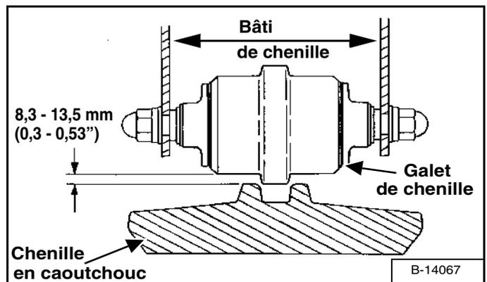
Mesurez l'écartement à l'un des galets du milieu. N'approchez pas les doigts du point de pincement entre la chenille et le galet. À l'aide d'un boulon ou d'un axe de taille adéquate, contrôlez l'écartement entre le bord de contact du galet et le bord supérieur du crampon de guidage de la chenille [Figure 203] et [Figure 204].
