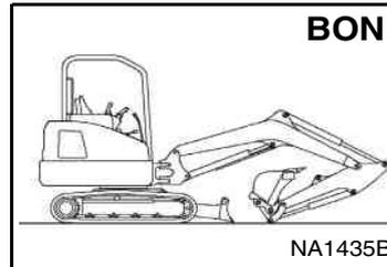
⚠ N'utilisez jamais une machine qui n'est pas équipée d'une cabine / d'un canopy approuvé.
