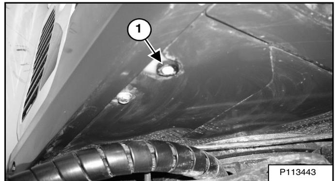
Tournez la tourelle de sorte que le bouchon de vidange du réservoir de carburant (1) soit entre les chenilles arrière. Retirez le bouchon de vidange (1) [Figure 169].
