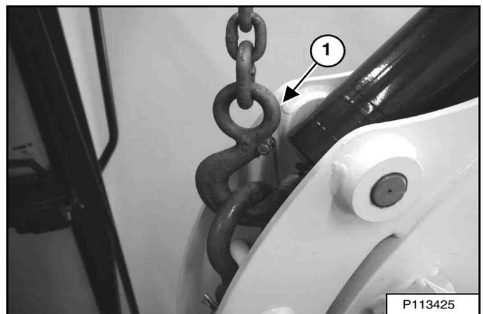
Fixez des chaînes aux extrémités de la lame (1) [Figure 143] et [Figure 144] et à un support de levage au-dessus de la cabine / du canopy. Le dispositif de levage doit s'étendre au-delà des côtés de la cabine ou du canopy pour éviter que les chaînes heurtent la protection ROPS / TOPS.
