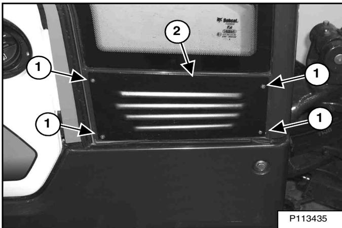
Retirez les quatre vis (1) et retirez le couvercle (2) [Figure 160].
