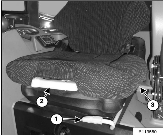
Libérez le levier du siège (1) [Figure 75] pour avancer ou reculer le siège.
