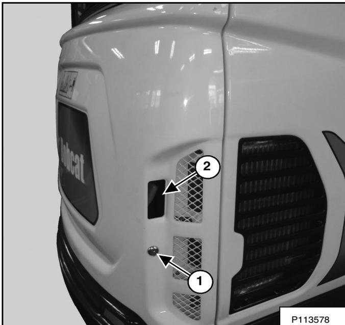
La porte arrière (1) se verrouille [Figure 155] à l'aide de la clé de contact.
