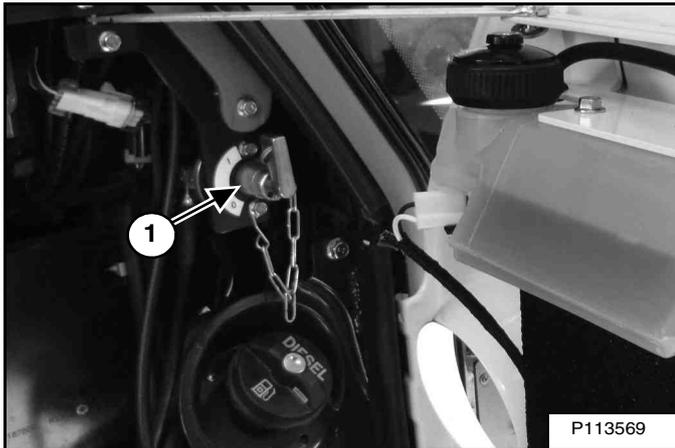
Le coupe-batterie (1) [Figure 184] se situe sous le capot latéral droit, au-dessus du bouchon du réservoir de carburant.
