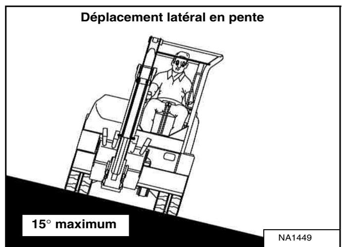
Lors de l'ascension d'une pente ou d'un déplacement latéral sur une pente de 15 degrés maximum, positionnez la machine comme illustré et faites tourner le moteur à bas régime [Figure 135] et [Figure 136].
