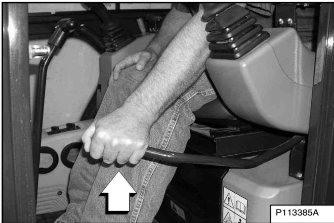
Tirez sur le levier de déverrouillage [Figure 14]. Le ressort de levage facilite le levage de la console.
