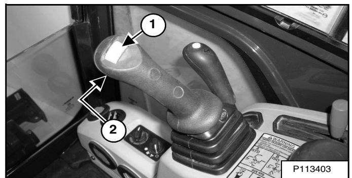
Déplacez le contacteur (1) [Figure 44] du manipulateur droit vers la droite pour alimenter le raccord rapide femelle en débit hydraulique. Déplacez le contacteur vers la gauche pour alimenter le raccord rapide mâle en débit hydraulique. Si le contacteur est placé à mi-course, les fonctions auxiliaires se déplacent à une vitesse réduite environ de moitié.
