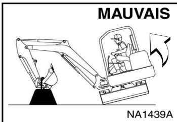
⚠ Maniez la machine avec précaution afin d'éviter qu'elle ne bascule. Ne faites jamais pivoter une charge lourde perpendiculairement aux chenilles.
