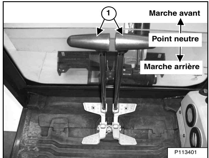
Pour freiner la machine en descendant une pente, ramenez les leviers de direction (1) [Figure 138] au *POINT NEUTRE*. Cela permet d'activer le frein hydrostatique.
