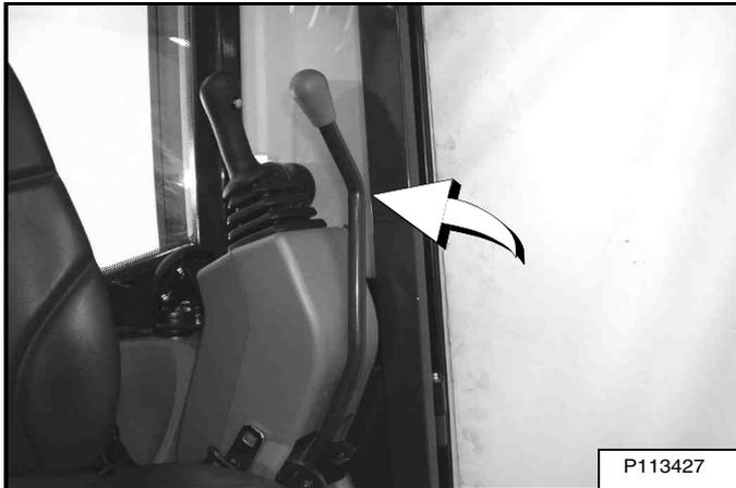
Lorsque la console gauche est relevée **[Figure 149]**, les manipulateurs et le système de translation ne doivent pas fonctionner.
