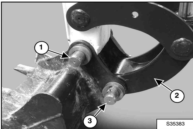
Positionnez le balancier sur le godet et alignez les trous de montage.
