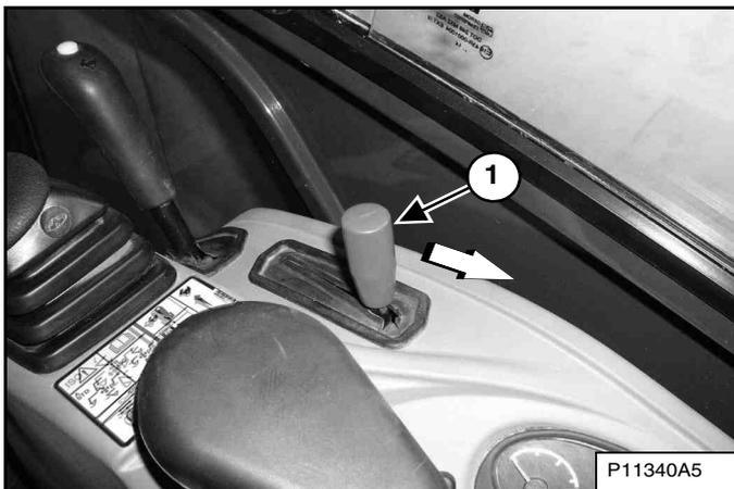
Tirez le levier d'accélérateur (1) [Figure 82] vers l'arrière en position de ralenti.
