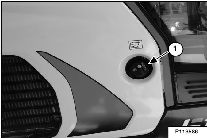
Le bouchon du réservoir de carburant se déverrouille à l'aide de la clé de contact.
