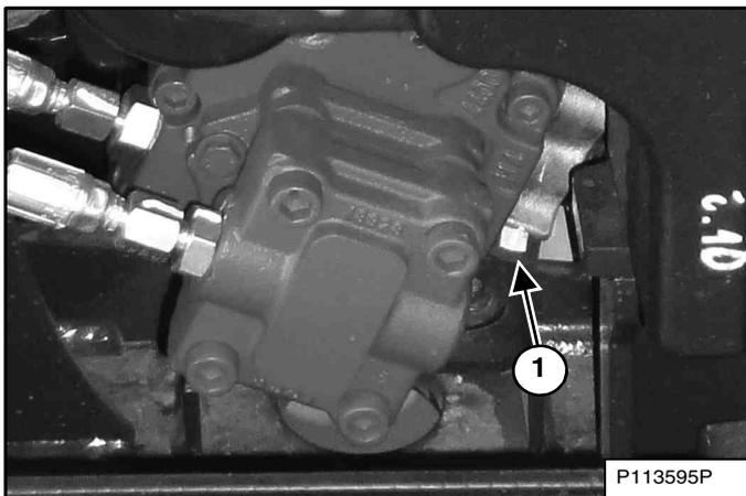
Le bouchon de vidange d'huile hydraulique (1) [Figure 197] se trouve sur le raccord d'admission de la pompe hydraulique.
