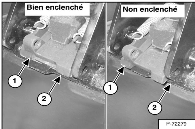
Contrôlez visuellement l'enclenchement du verrou de l'attache rapide (1) dans le châssis de fixation du godet (2) [Figure 107]. Le verrou doit être enclenché à fond.
