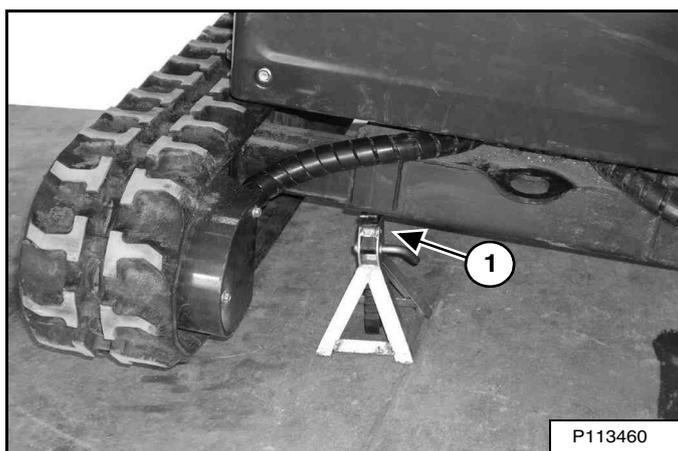
Levez complètement la lame et placez des chandelles sous la lame et le châssis inférieur (1) [Figure 201] et [Figure 202]. Levez la flèche jusqu'à ce que tout le poids de la machine soit soutenu par les chandelles.
