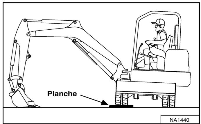
Si une ou les deux chenilles s'embourbent dans un sol meuble ou humide, relevez une chenille à la fois en faisant pivoter la tourelle et en exerçant une pression contre le sol avec le godet [Figure 132].
