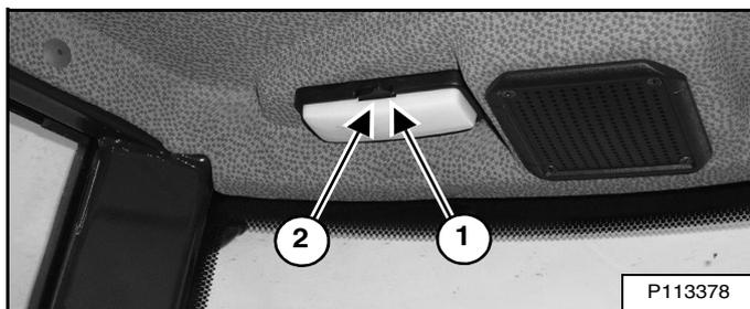
Appuyez sur la droite du contacteur (1) pour allumer l'éclairage. Appuyez sur la gauche du contacteur (2) [Figure 7] pour éteindre l'éclairage.
