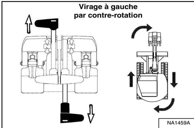
Poussez le levier de direction gauche vers l'avant et tirez le levier de direction droit vers l'arrière [Figure 35].
