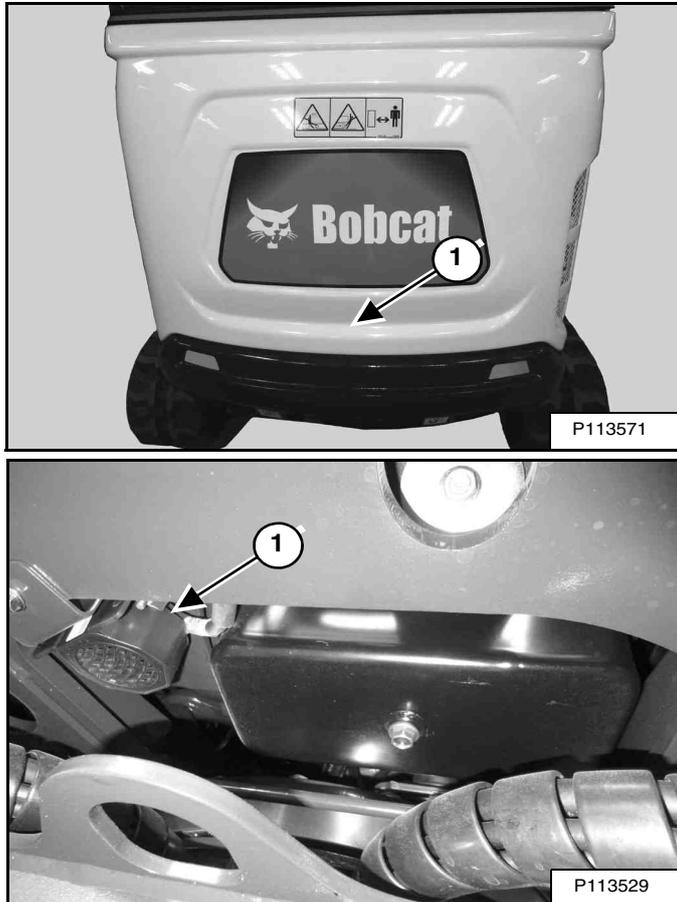
La pelle compacte peut être équipée d'un système d'alarme de déplacement. L'avertisseur de déplacement se situe dans la partie arrière (1) [Figure 31] de la pelle compacte.
