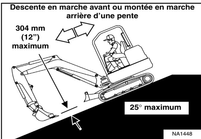
Pour descendre une pente dont l'inclinaison est supérieure à 15 degrés, placer la machine dans la position illustrée et se déplacer lentement [Figure 134].
