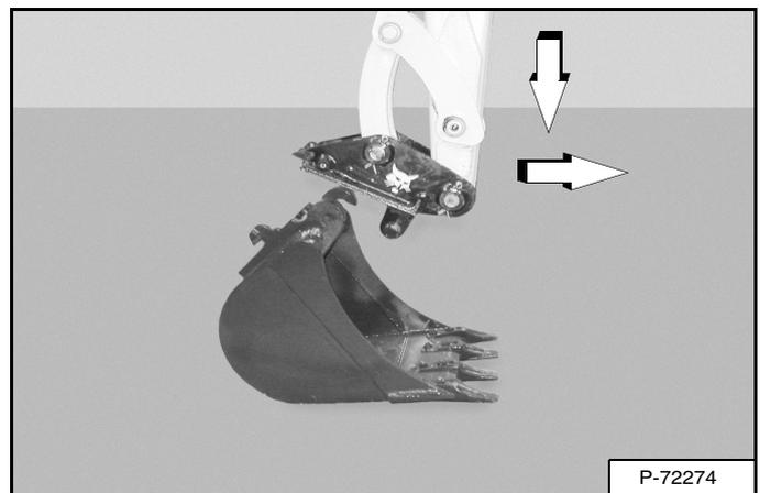
Continuez d'abaisser la flèche en déplaçant le balancier vers la pelle compacte jusqu'à ce que l'attache rapide soit dégagée de l'accessoire [Figure 111].
