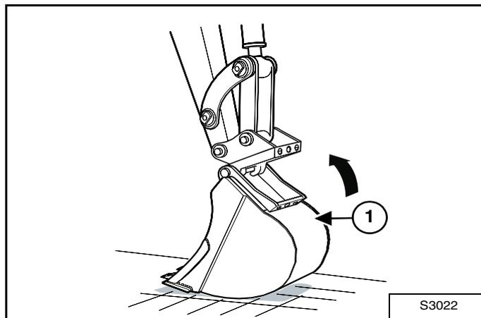
Rétractez le vérin de godet pour sortir l'attache rapide Bobcat de l'adaptateur [Figure 98].
