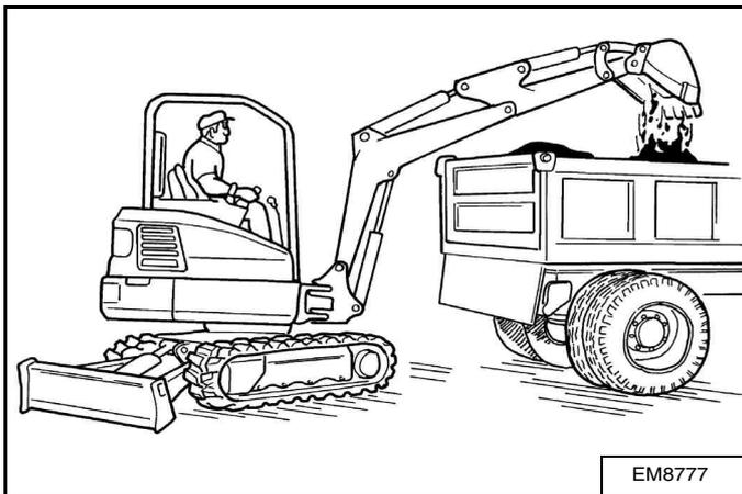
Étendez le balancier et ouvrez le godet pour déverser la charge dans une benne ou sur un tas [Figure 125].
