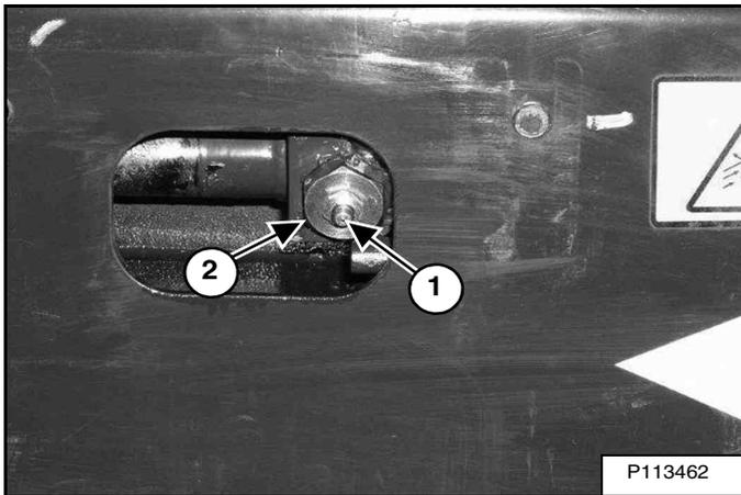
Desserrez les vis du panneau d'accès et faites pivoter le panneau pour l'ouvrir [Figure 205].
