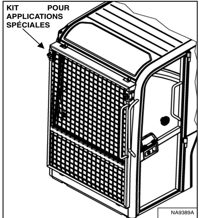
Pour répondre aux exigences de protection du pare-brise de la norme ISO 10262 – niveau 1, la pelle compacte doit être équipée du kit pour applications spéciales [Figure 6].
