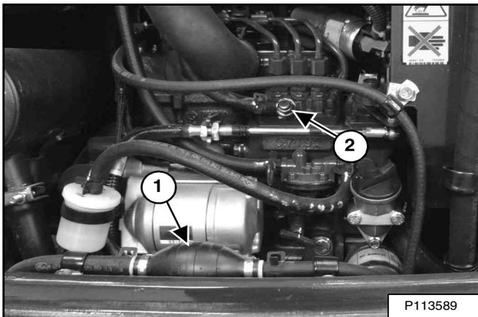
Ouvrez la vis de purge (1) [Figure 171] et actionnez la pompe manuelle (poire d'amorçage) (1) [Figure 172] jusqu'à ce que du carburant exempt de bulles d'air s'écoule par la vis (1) [Figure 171].
