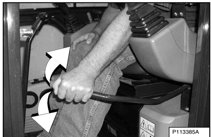
Le contacteur de verrouillage des manipulateurs désactive les fonctions de travail et de translation lorsque la console est relevée [Figure 113].
