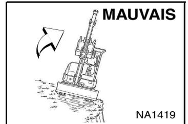
⚠ Évitez les zones abruptes et les remblais susceptibles de s'effondrer sous la machine.
