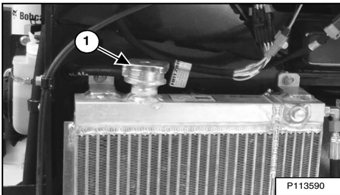
Lorsque le moteur est froid, desserrez et retirez le bouchon de remplissage du liquide de refroidissement (1) [Figure 179].
