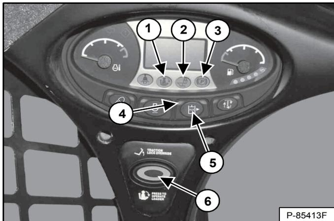
1. Installez-vous dans le siège de l'opérateur. Tournez le contacteur à clé sur la position MARCHÉ. Abaissez l'arceau de siège et libérez le frein de stationnement. Appuyez sur le bouton PRESS TO OPERATE LOADER (APPUYER POUR UTILISER LA CHARGEUSE) (6). Les deux témoins BICS™ (1 et 2) [Figure 168] [ARCEAU DE SIÈGE et LEVAGE ET CAVAGE] du tableau de bord gauche doivent être ÉTEINTS. Le bouton PRESS TO OPERATE LOADER (APPUYER POUR UTILISER LA CHARGEUSE) s'allume.
