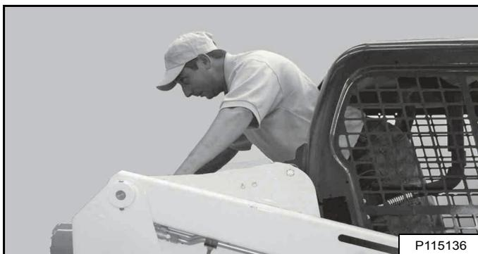
Sortez de la chargeuse par l'arrière de la cabine [Figure 48].
