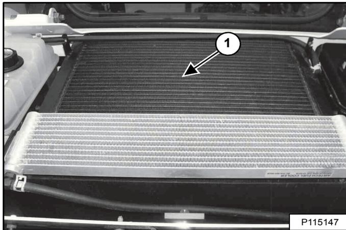
Nettoyez le dessus de l'ensemble refroidisseur d'huile hydraulique et radiateur avec de l'air ou de l'eau à basse pression (1) [Figure 225].
