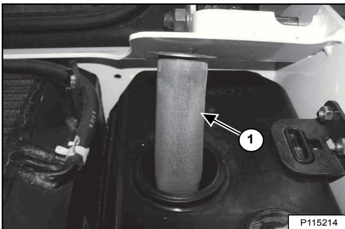
Déposez et nettoyez la crépine de remplissage d'huile hydraulique (1) [Figure 263]. Nettoyez la crépine avec de l'air à basse pression.
