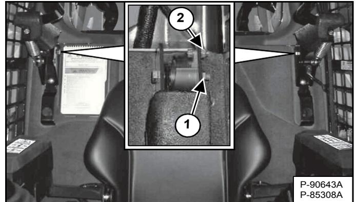
Éliminez les débris ou les saletés des points pivots à l'air comprimé. Ne lubrifiez pas. Contrôlez la visserie de fixation. Le couple de serrage correct de l'écrou d'articulation (des deux côtés) (1) est de 34 à 38 Nm (25 à 28 ft.-lb.). Le couple de serrage de l'écrou du capteur de l'arceau de siège (côté gauche uniquement) (2) [Figure 170] est de 6 à 8 Nm (50 à 70 in.-lb.).
