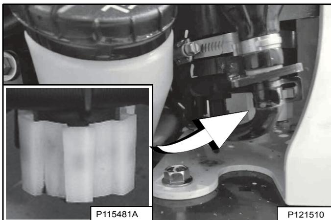
Desserrez le purgeur (médaillon) [Figure 211] situé au bas du filtre pour vidanger l'eau emprisonnée dans le filtre.
