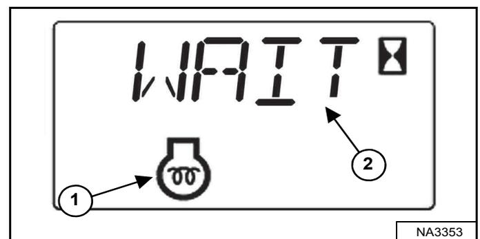
Si la température est basse, les bougies de préchauffage s'allument automatiquement. L'icône du préchauffage du moteur (1) et le temps de préchauffage restant ou [WAIT] (2) [Figure 124] s'affichent sur l'écran des données.
