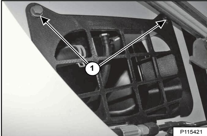
Déposez les boulons (1) du capot d'accès droit [Figure 270] et retirez le capot.
