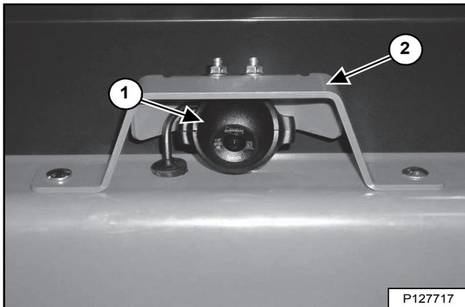
La caméra de recul (1) est fixée à l'intérieur d'un support (2) [Figure 23] monté sur la porte arrière.
