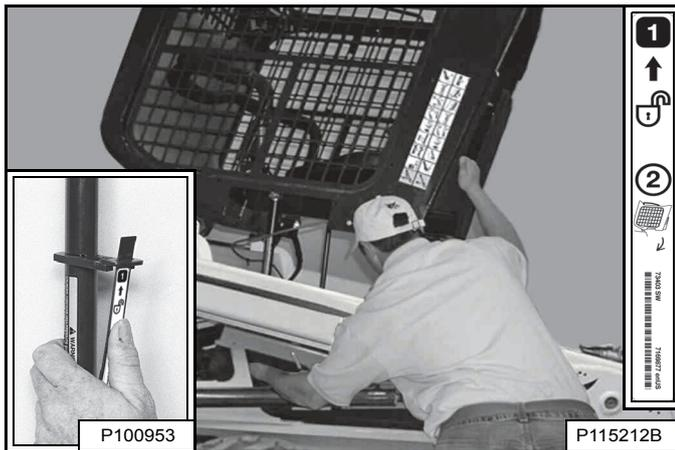
Tirez vers le bas la partie inférieure de la cabine jusqu'à ce qu'elle se cale sur le mécanisme de verrouillage [Figure 188].
