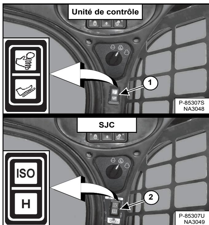
(ACS) Sélectionnez le fonctionnement par commandes manuelles ou par pédales (1) [Figure 125] si la machine est équipée de commandes ACS.
