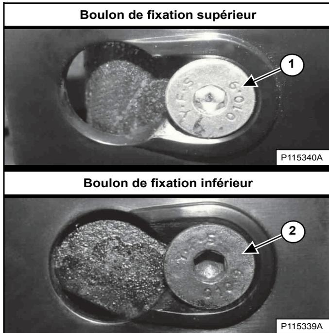
Placez le capot de la courroie d'entraînement au-dessus des vis de fixation du capot. Faites glisser le capot de la courroie d'entraînement vers l'avant de la chargeuse pour totalement engager le capot sur les boulons de fixation inférieur et supérieur (1 et 2) [Figure 298].
