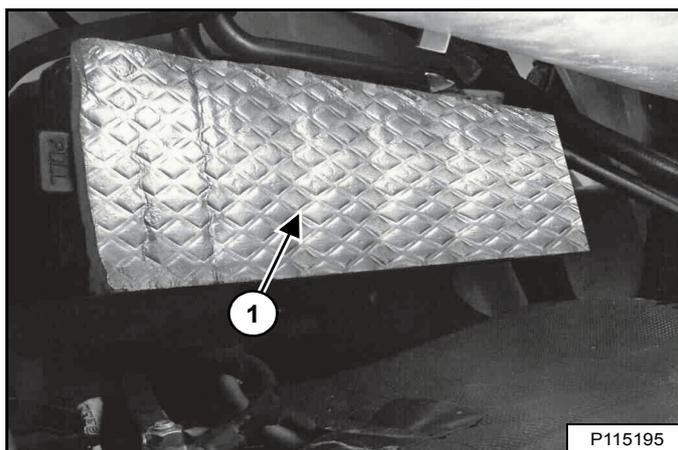
Le circuit électrique est protégé contre les surcharges par des fusibles situés sous le couvercle du boîtier de fusibles (1) [Figure 234]. Retirez le couvercle en le tirant par ses deux extrémités.
