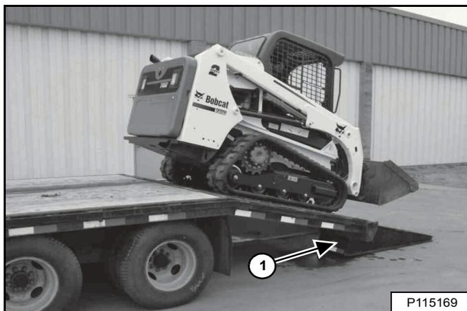
Faites monter la chargeuse en marche arrière sur le véhicule de transport si le godet est vide, ou si l'accessoire a été déposé [Figure 166].
