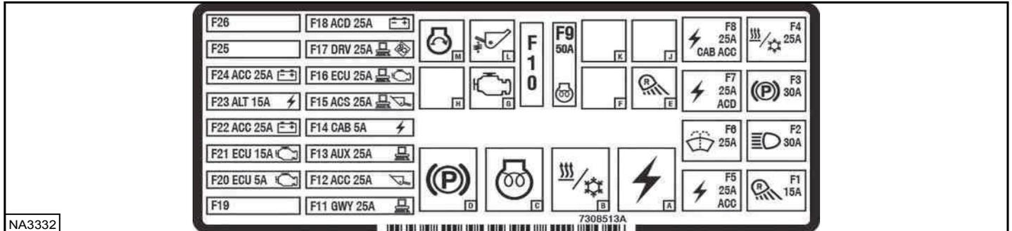
Le tableau ci-dessous correspond aux modèles récents avec l'autocollant réf. 7308513. Les emplacements et les ampérages des fusibles sont indiqués dans le tableau ci-dessous et sur l'autocollant [Figure 238]. Les relais sont identifiés par la lettre « R » dans la colonne AMP.
