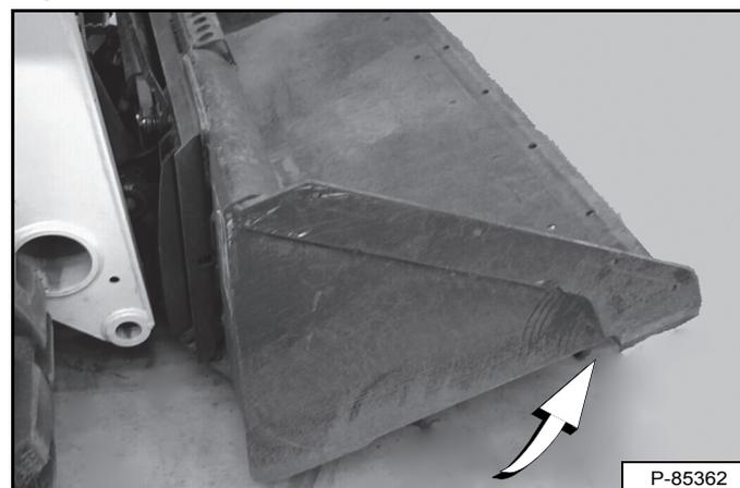
Inclinez le Bob-Tach vers l'arrière jusqu'à ce que le bord d'attaque du godet (ou autre accessoire) décolle légèrement du sol [Figure 148]. Cette procédure permet au châssis de fixation du godet de se plaquer contre l'avant du Bob-Tach.
