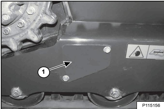
Les raccords de tension des chenilles utilisés pour régler la tension des chenilles sont situés derrière les capots d'accès (1) [Figure 281] (côté droit illustré).
