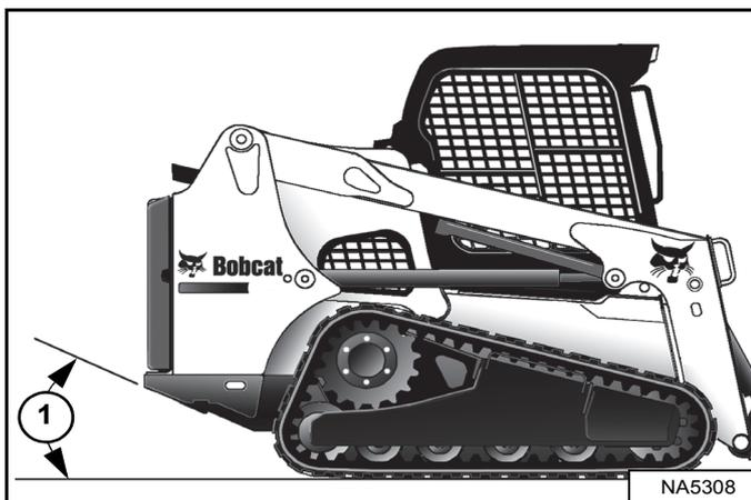
**REMARQUE :** la chargeuse doit être levée autant que possible à l'horizontale, mais l'angle de la chargeuse suspendue ne doit en aucun cas dépasser l'angle de dégagement (1) [Figure 164] indiqué dans les caractéristiques techniques. (Voir Dimensions page 220.)
