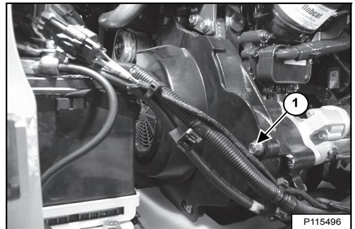
Installez le boulon du capot de la courroie d'entraînement (1) [Figure 299].
