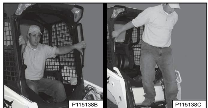
Sortez de la chargeuse en utilisant les mains courantes, les antidérapants et les marchepieds (en maintenant un contact en trois points) [Figure 136].
