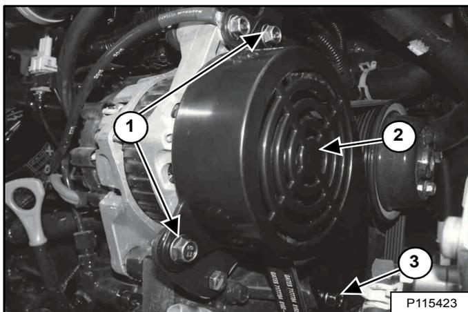
Déposez les boulons et les écrous de fixation du capot de la courroie d'entraînement (1). Dévissez le boulon de fixation (3) [Figure 287].
