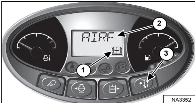
Remplacez les filtres à air uniquement lorsque cela s'avère nécessaire. Le témoin d'entretien (1) CLIGNOTE. Appuyez sur le bouton Information (3) jusqu'à ce que l'écran affiche les codes de service. Le code de service **[AIRF]** (Remplacer le filtre à air) ou **[M0117]** (Filtre à air obstrué) s'affiche sur l'écran des données (2) **[Figure 204]** lorsque le filtre doit être remplacé.
