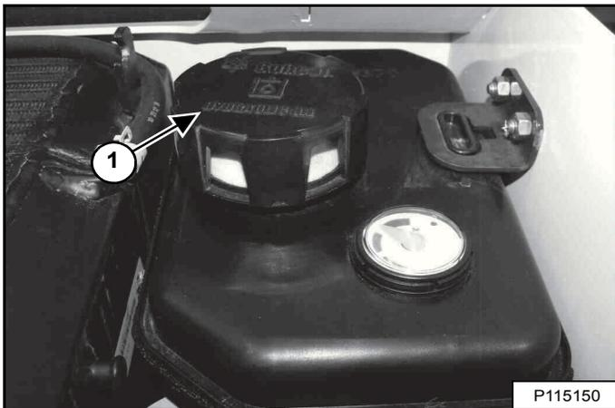
Déposez le bouchon de remplissage hydraulique (1) [Figure 258].
