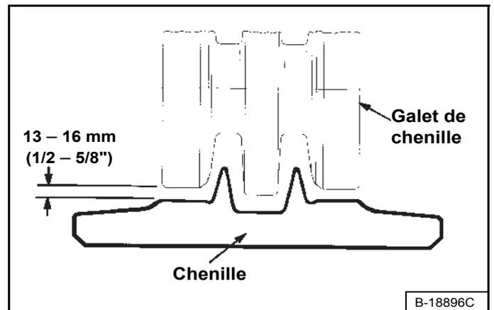
N'introduisez JAMAIS les doigts dans l'espace entre la chenille et le galet. Contrôlez l'espacement à l'aide d'une cale, d'une douille ou d'un boulon de 13 à 16 mm (1/2 à 5/8") [Figure 275] et [Figure 276].
