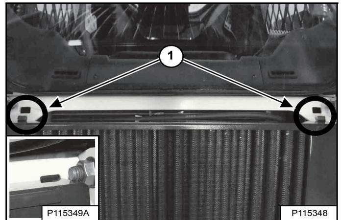
Le bord avant de la grille arrière comporte deux ergots qui s'emboîtent dans les logements présents sur le châssis de la chargeuse (1) [Figure 194]. Insérez les ergots dans les logements et abaissez la grille arrière.
