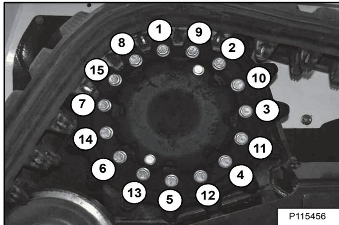
Vérifiez le couple de serrage des quinze boulons de barbotins de chenille (1 à 15) [Figure 286]. Utilisez une séquence de serrage alternative et répétez-la pour serrer les boulons au couple de 122,0 à 135,6 Nm (90 à 100 ft.-lb.).
