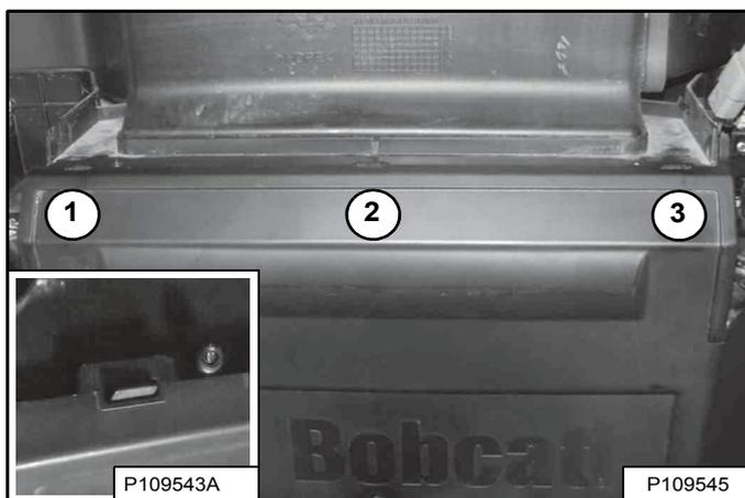
2. Poussez le capot vers le haut aux trois emplacements indiqués (1, 2 et 3) jusqu'à ce que les logements s'emboîtent sur les ergots. Ce logement (médaillon) [Figure 202] est correctement fixé.
