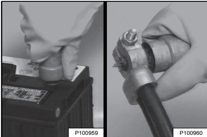
Nettoyez toujours les bornes et les extrémités des câbles lors de l'installation d'une batterie neuve ou usagée [Figure 247].
