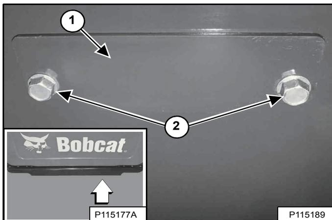
Le flexible de vidange d'huile est situé derrière un capot (1) sous l'arrière de la chargeuse (médaillon) [Figure 216].
