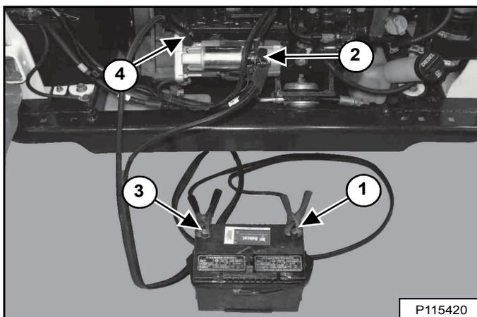
Raccordez une extrémité du premier câble (1) à la borne positive (+) de la batterie d'appoint. Raccordez l'autre extrémité de ce câble (2) [Figure 241] à la borne positive (+) du démarreur du moteur.
