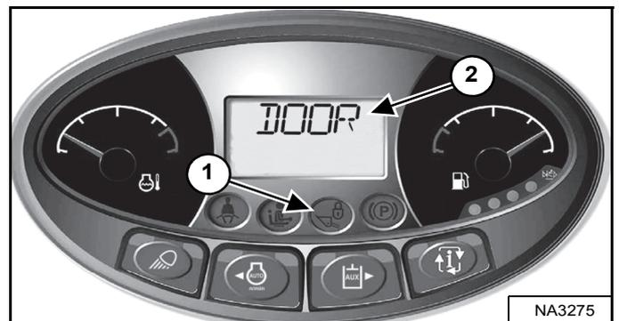
Le témoin de LEVAGE ET CAVAGE (1) [Figure 184] est ÉTEINT lorsque la porte est fermée, que le contacteur à clé est placé sur la position MARCHE, que l'arceau de siège est abaissé et que le bouton PRESS TO OPERATE LOADER (APPUYER POUR UTILISER LA CHARGEUSE) est enfoncé.
