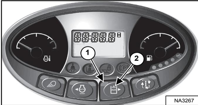
Appuyez une fois sur le bouton du circuit hydraulique auxiliaire (2) [Figure 94] pour l'activer.
