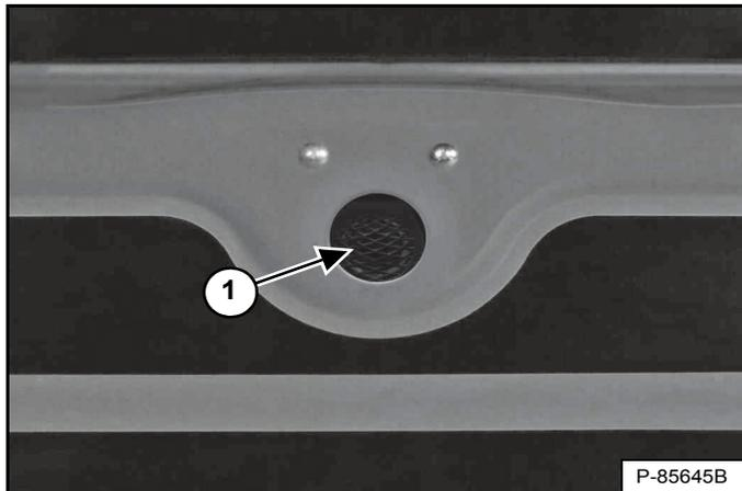
L'alarme de recul (1) [Figure 57] est située à l'intérieur de la porte arrière.
