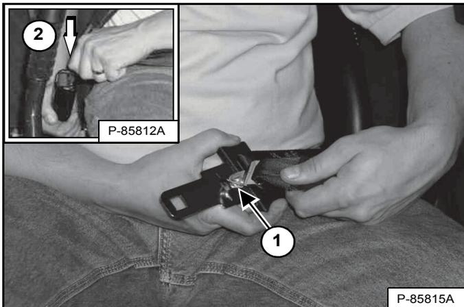
**REMARQUE :** la ceinture de sécurité à 3 points doit être utilisée lorsque vous sélectionnez la grande vitesse [Figure 66].
