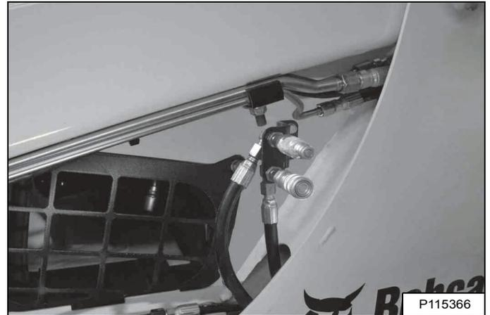
Déplacez le contacteur du circuit hydraulique auxiliaire arrière (1) [Figure 95] ou [Figure 96] vers la droite ou vers la gauche pour inverser le débit d'huile hydraulique des raccords rapides arrière [Figure 97]. (côté gauche en illustration). (EXEMPLE : montée et descente des stabilisateurs arrière). Relâchez le contacteur pour arrêter le débit d'huile.
