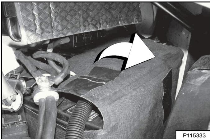
Ouvrez le rabat supérieur de la sacoche de la batterie pour accéder aux bornes de la batterie [Figure 244].
