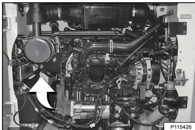
Le compresseur de climatisation se trouve derrière le moteur, sur le côté droit de la chargeuse [Figure 293].
