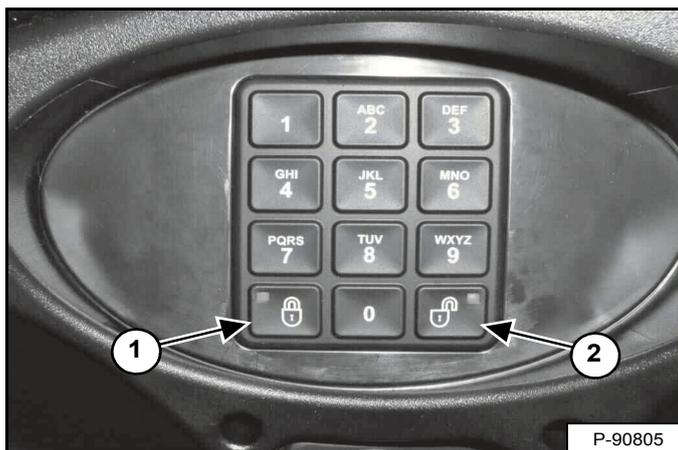
Enfoncez et maintenez enfoncés les boutons de verrouillage (1) et de déverrouillage (2) [Figure 319] pendant 2 secondes.
