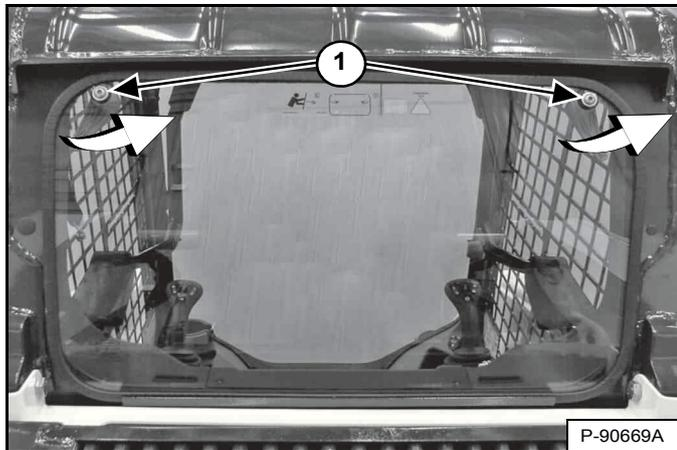
La vitre arrière peut être retirée depuis l'extérieur de la chargeuse à l'aide d'un tournevis T40 TORX®. Tournez chaque vis (1) [Figure 49] dans le sens anti-horaire jusqu'à ce que les loquets se dégagent du cadre de la vitre. Tirez le haut de la vitre vers l'extérieur et soulevez la vitre pour la retirer.
