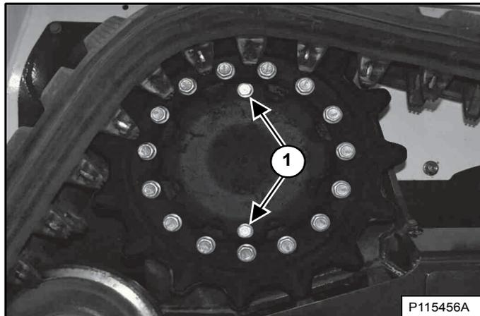
Stationnez la chargeuse de sorte que les bouchons (1) [Figure 285] du moteur d'entraînement hydrostatique se trouvent en bas et en haut.
