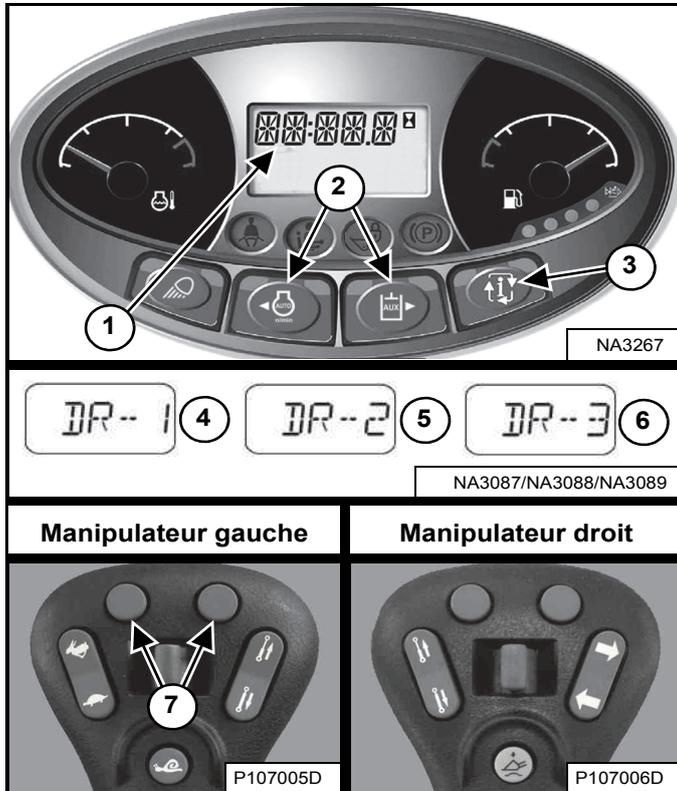
Appuyez sur le bouton « Information » (3) pour faire défiler l'affichage des données jusqu'à ce que le menu de la réaction d'entraînement s'affiche. Le réglage actuel de la réaction d'entraînement apparaît sur l'affichage des données (1) [Figure 72].
