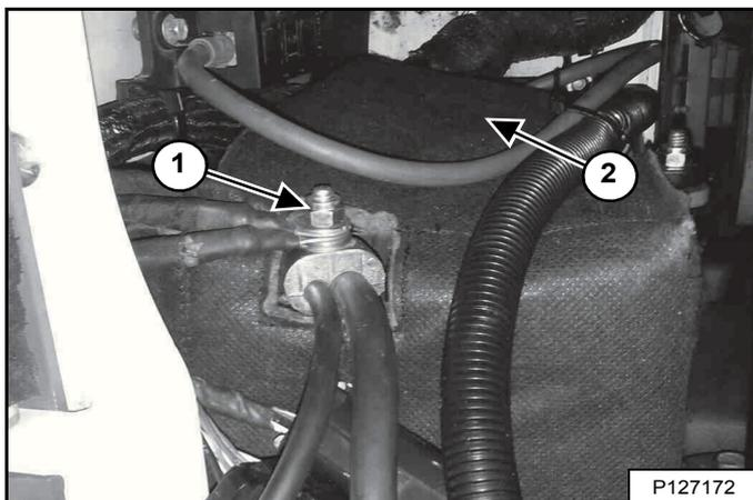
Retirez l'écrou du haut du câble négatif (-) (1) [Figure 250]. Retirez les câbles.
