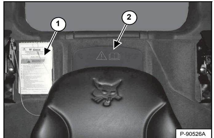
Lisez et comprenez le contenu du Manuel de l'Opérateur et d'Entretien et du Guide de l'Opérateur (1) [Figure 108] avant d'utiliser la chargeuse.
