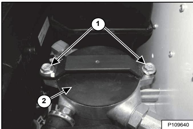
Desserrez les boulons (1) et tournez le bouchon du filtre (2) [Figure 264] vers la gauche jusqu'à soulever les boulons.
