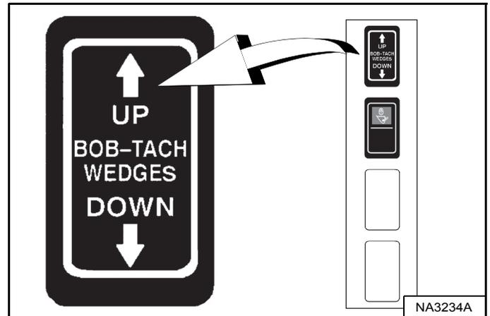
Appuyez sur le côté UP du contacteur BOB-TACH WEDGES (Montée des cales) (panneau des contacteurs droit) et maintenez-le enfoncé [Figure 152] jusqu'à ce que les leviers soient complètement engagés (cales complètement relevées).
