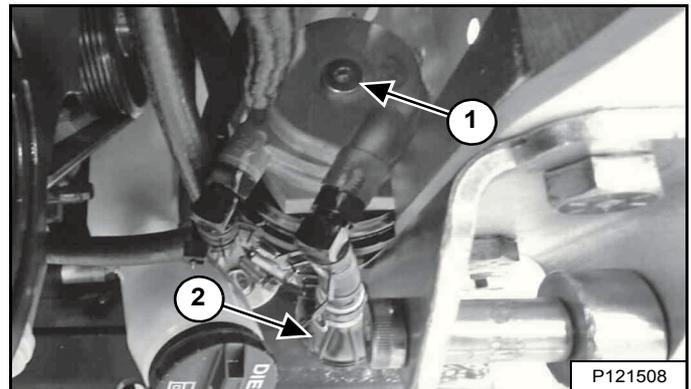
Ouvrez le purgeur d'air (1) [Figure 213] situé sur l'ensemble du filtre à carburant de trois tours.
