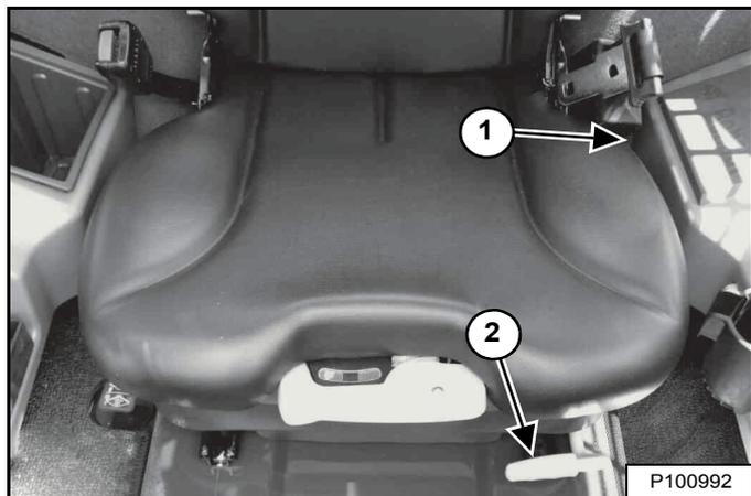
Levez le levier (1) [Figure 109] pour ajuster l'inclinaison du dossier du siège.
