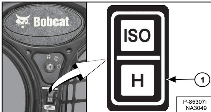
Sélectionnez le schéma de commande H en appuyant sur le bas du contacteur (1) [Figure 63].
