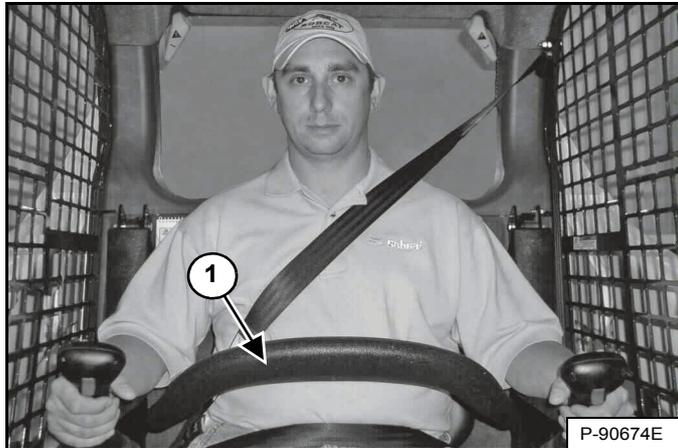
Le dispositif de sécurité de l'arceau de siège comprend un arceau de siège pivotant avec accoudoirs (1) [Figure 37].
