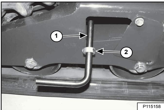
Installez l'outil purgeur (6675936) (1) sur le raccord purgeur, réglez et serrez le collier (2) [Figure 279] de sorte qu'il se place derrière le bord du capot d'accès (côté droit illustré).
