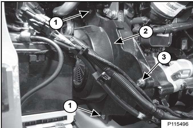
Déposez le boulon du capot de la courroie d'entraînement (3) [Figure 296].
