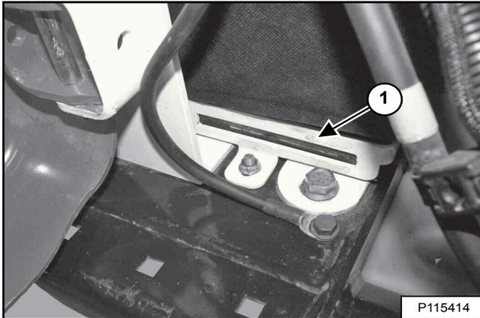
Les anciens modèles utilisent une bride (1) [Figure 242] placée à la base de la batterie. (voir Dépose (anciens modèles), page 167).
