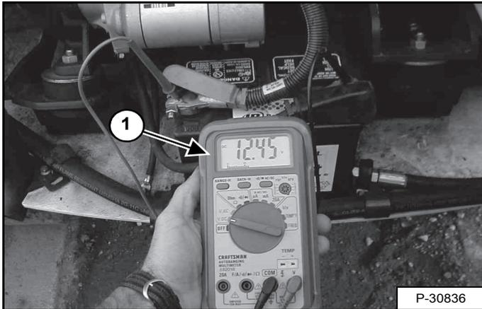
Le moyen le plus simple et le plus courant pour déterminer le niveau de charge d'une batterie est d'utiliser un multimètre numérique ou un voltmètre (1) [Figure 240].
