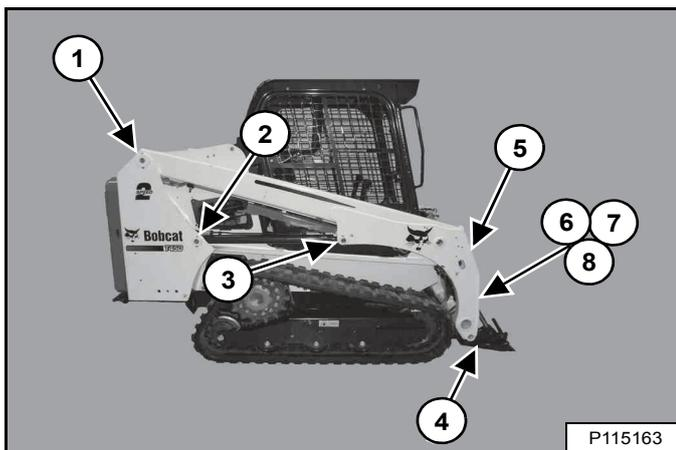
Les emplacements des graisseurs [Figure 300] sont indiqués plus en détail dans les figures suivantes.
