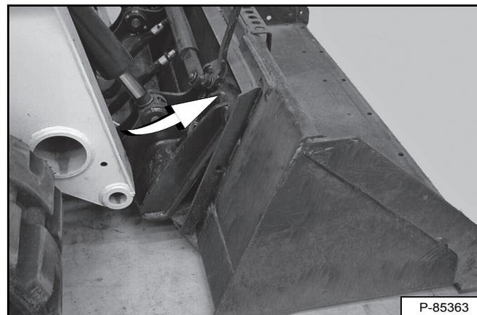
Avancez lentement la chargeuse jusqu'à ce que le bord supérieur du Bob-Tach soit complètement sous le gousset supérieur du châssis de fixation du godet [Figure 147] (ou autre accessoire).
