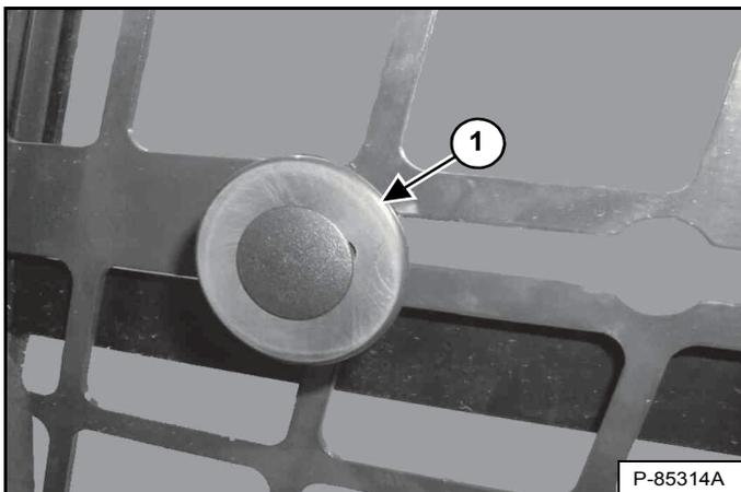
Tirez le bouton (1) [Figure 29] et ouvrez la vitre en la faisant coulisser vers l'arrière. Relâchez le bouton au niveau de la découpe pour verrouiller la vitre dans la position voulue. Tirez le bouton et faites coulisser la vitre vers l'avant pour la fermer.
