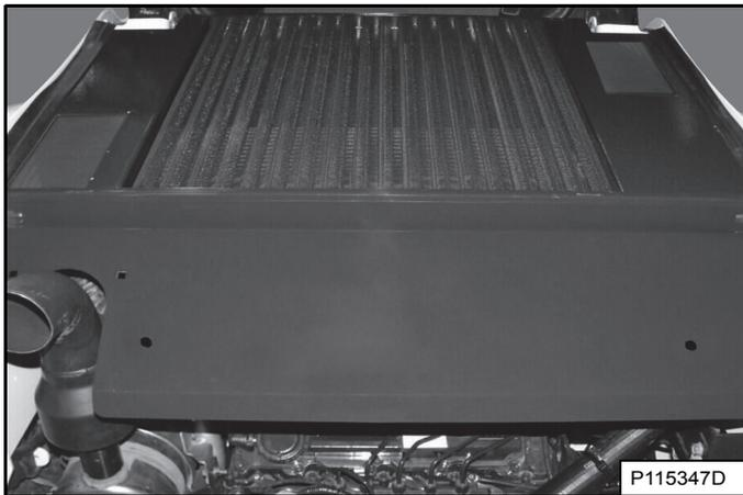
Soulevez la grille arrière et tirez-la vers l'arrière pour la retirer de la chargeuse [Figure 193].
