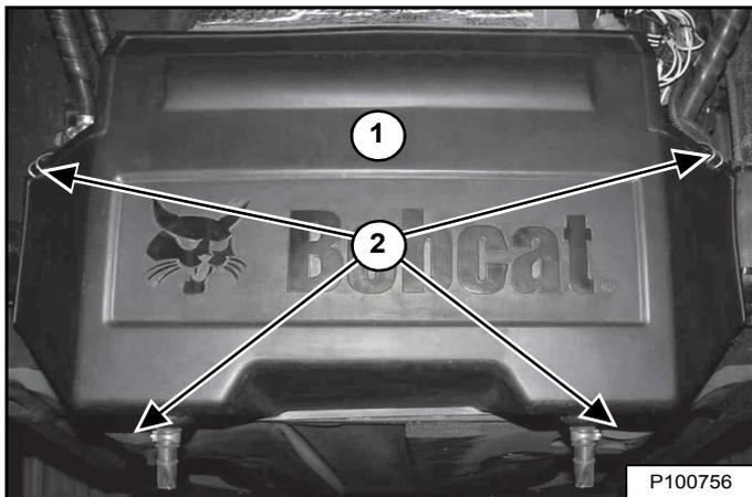
Ouvrez les attaches (2) et déposez le capot (1) [Figure 197].
