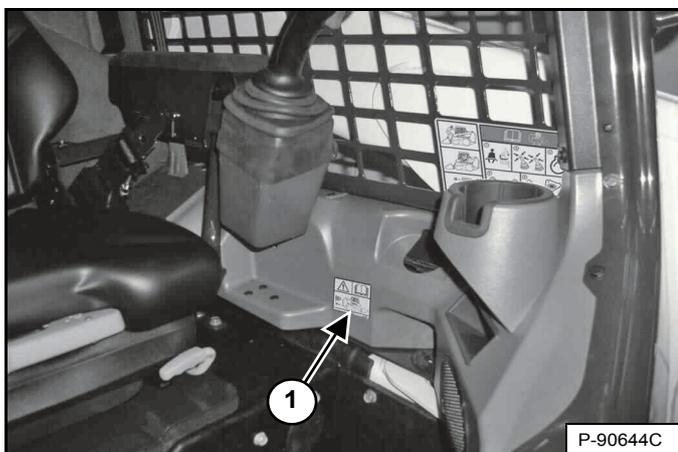
Assurez-vous que l'autocollant de l'alarme de recul (1) n'est ni endommagé ni manquant [Figure 179]. Remplacez-le si nécessaire.
