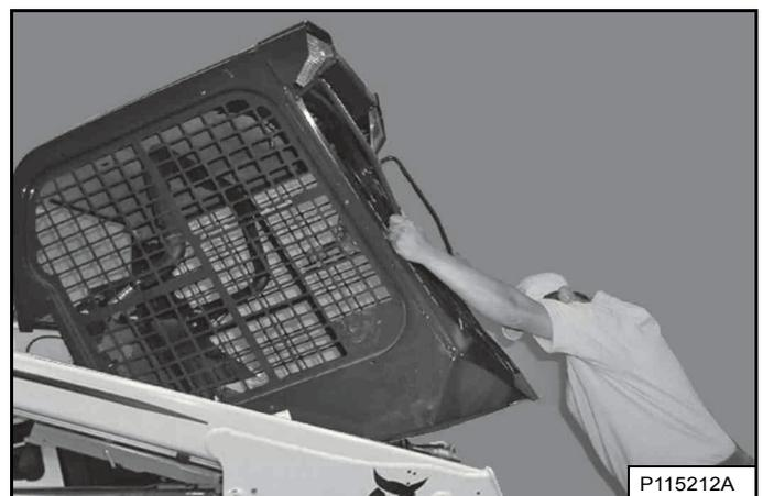
Levez lentement la cabine de l'opérateur par les mains courantes et le bas de la cabine [Figure 187] jusqu'à ce qu'elle soit complètement levée et que son mécanisme de verrouillage s'enclenche.
