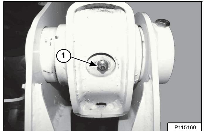
1. Axe pivot des bras de levage (des deux côtés) (2) [Figure 301].
