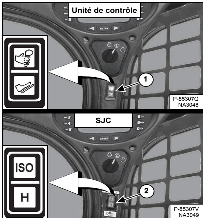
(ACS) Sélectionnez le fonctionnement par commandes manuelles ou par pédales (1) [Figure 130] si la machine est équipée de commandes ACS.
