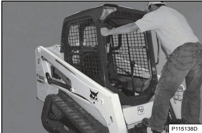
Utilisez les marchepieds du godet ou de l'accessoire, les mains courantes et l'antidérapant (sur les bras de levage et le châssis de la chargeuse) pour monter et descendre de la chargeuse en maintenant en permanence un contact en trois points [Figure 107]. Ne sautez pas.
