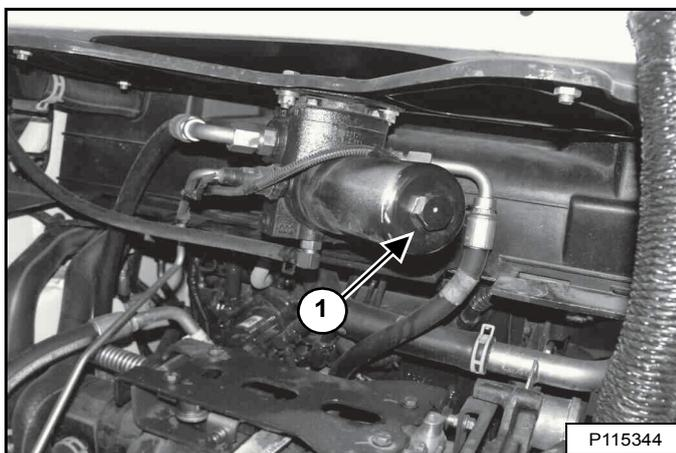
Placez un récipient approprié sous le logement du filtre et retirez le logement (1) [Figure 268].
