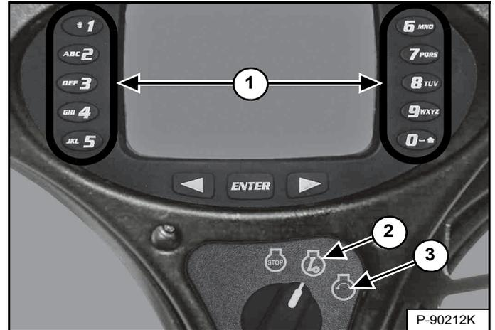
Tournez le contacteur à clé sur la position MARCHÉ (2). Les témoins du tableau de bord gauche s'ALLUMENT brièvement tandis que le tableau de bord/système de surveillance exécute un test automatique. Utilisez le pavé numérique (1) [Figure 128] pour saisir le mot de passe.
