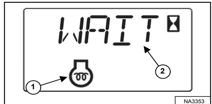
Si la température est basse, les bougies de préchauffage s'allument automatiquement. L'icône du préchauffage du moteur (1) et le temps de préchauffage restant ou [WAIT] (2) [Figure 119] s'affichent sur l'écran des données.
