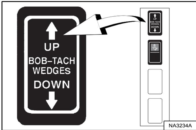
Appuyez sur le côté UP du contacteur BOB-TACH WEDGES (Montée des cales) (panneau des contacteurs droit) et maintenez-le enfoncé [Figure 149] jusqu'à ce que les leviers soient complètement engagés (cales complètement relevées).
