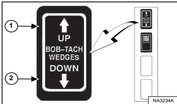
Enfoncez et maintenez enfoncé le CÔTÉ UP DU CONTACTEUR BOB-TACH WEDGES (Montée des cales) (1) jusqu'à ce que les cales soient complètement relevées. Enfoncez et maintenez enfoncé le CÔTÉ DOWN DU CONTACTEUR BOB-TACH WEDGES [Figure 313] (Descente des cales) (2) jusqu'à ce que les cales soient complètement abaissées
