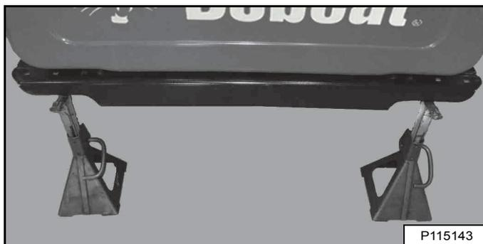
Placez des chandelles sous les coins arrière du châssis de la chargeuse [Figure 185].
