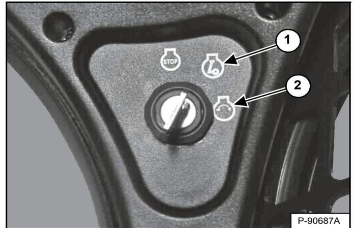
Tournez le contacteur à clé sur la position MARCHÉ (1) [Figure 118]. Les témoins du tableau de bord gauche s'ALLUMENT brièvement tandis que le tableau de bord/système de surveillance exécute un test automatique.
