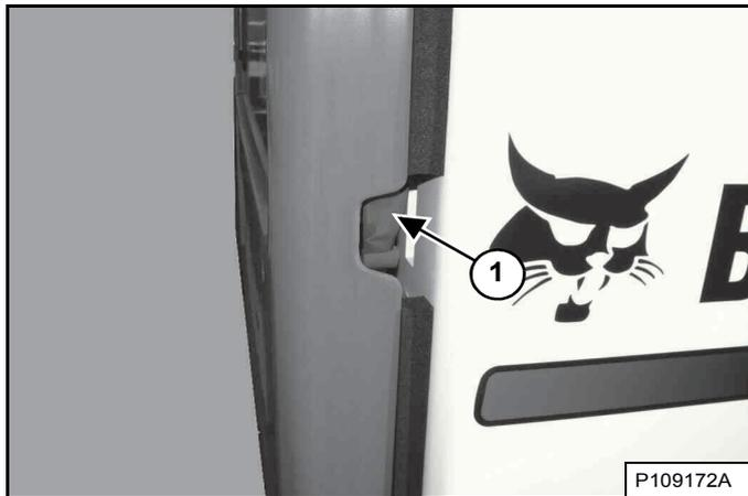
Passez la main dans l'encoche sur le côté droit de la porte arrière et tirez le loquet (1) [Figure 190]. Ouvrez la porte arrière en tirant dessus.
