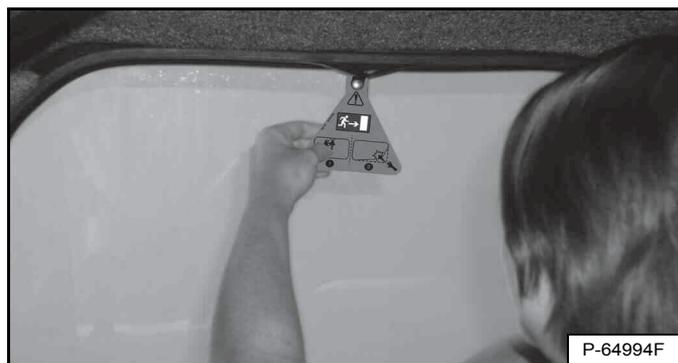
Tirez sur l'étiquette en haut de la vitre arrière pour retirer le cordon en caoutchouc [Figure 47].
