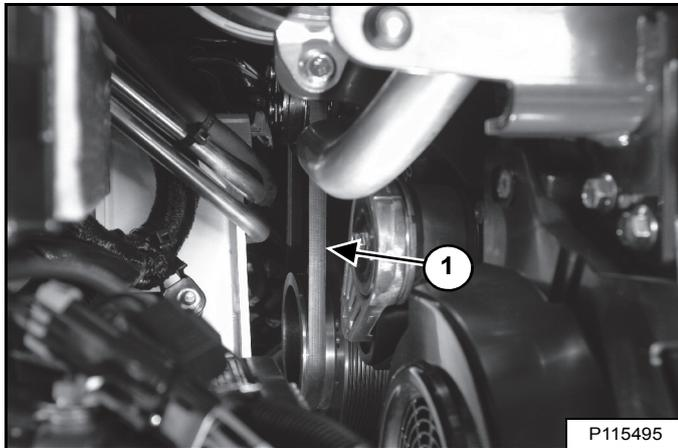
Coupez la courroie usagée (1) [Figure 294] et retirez-la des poulies. Contrôlez l'usure des poulies.
