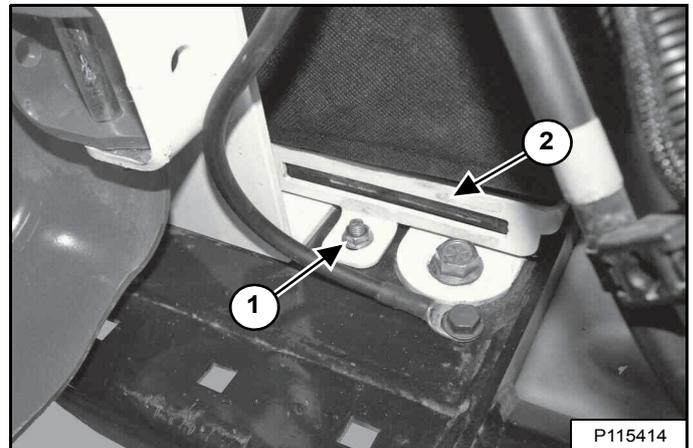
Installez la bride de la batterie (2) et l'écrou (1) [Figure 248].
