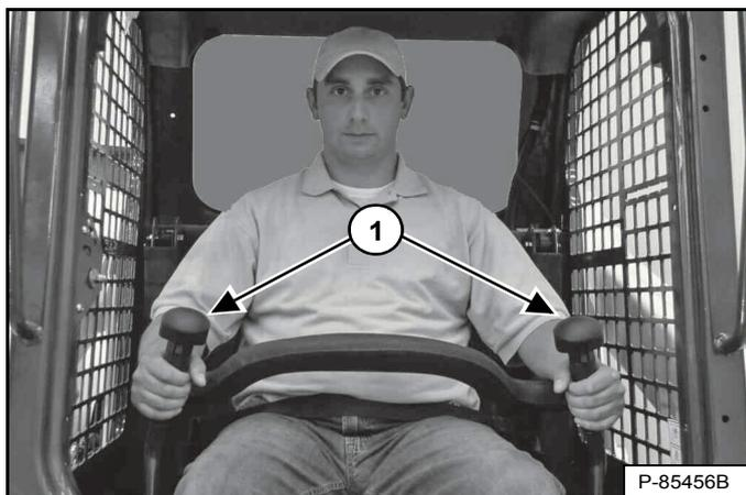
Les leviers de direction (1) [Figure 58] se trouvent à droite et à gauche à l'avant du siège.
