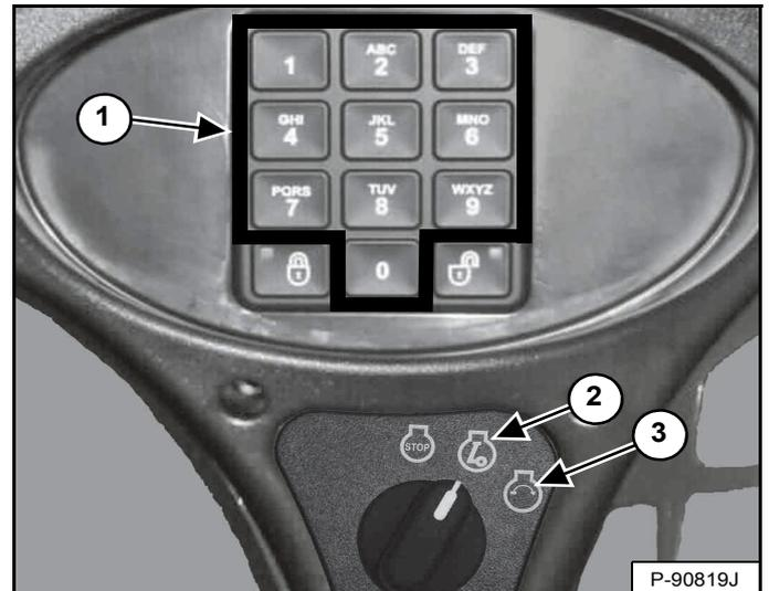
Tournez le contacteur à clé sur la position MARCHÉ (2). Les témoins du tableau de bord gauche s'ALLUMENT brièvement tandis que le tableau de bord/système de surveillance exécute un test automatique. Utilisez le pavé numérique (1) [Figure 123] pour saisir le mot de passe.
