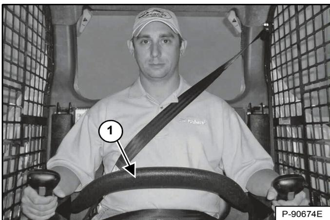
Le dispositif de verrouillage Bobcat (BICS™) comprend un arceau de siège pivotant avec accoudoirs (1) [Figure 35]. L'utilisation de l'arceau de siège est commandée par l'opérateur.
