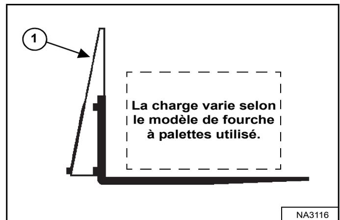
La charge maximale pouvant être déplacée à l'aide de fourches à palettes est indiquée sur un autocollant situé sur le châssis des fourches (1) [Figure 138].
