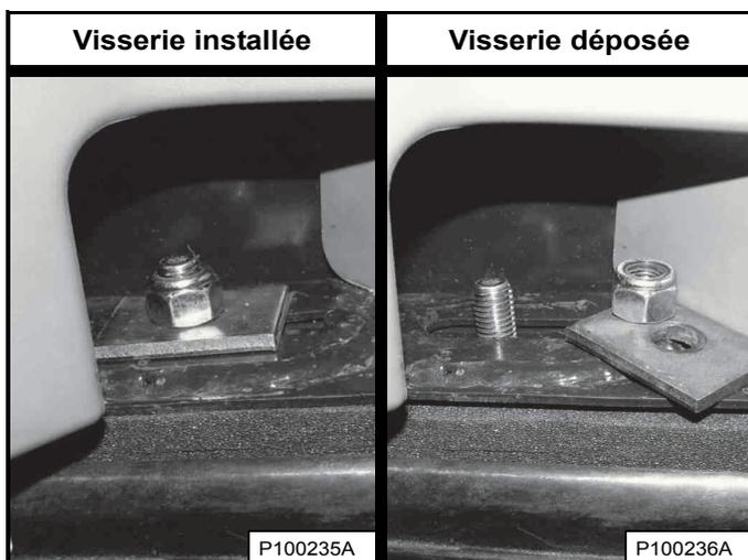
Déposez les écrous et les rondelles [Figure 186] (des deux côtés) situés dans les coins avant de la cabine.
