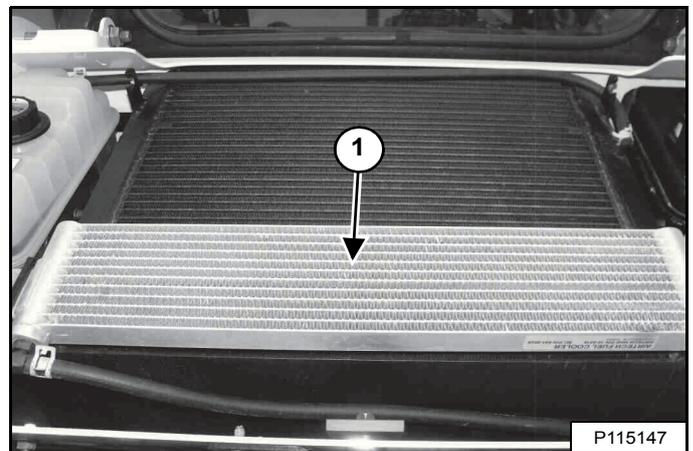
Nettoyez le dessus du refroidisseur de carburant (1) [Figure 221] avec de l'air ou de l'eau à basse pression.
