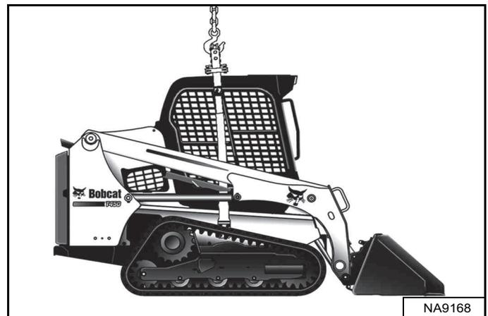
Fixez le crochet de levage au point de levage [Figure 163].
