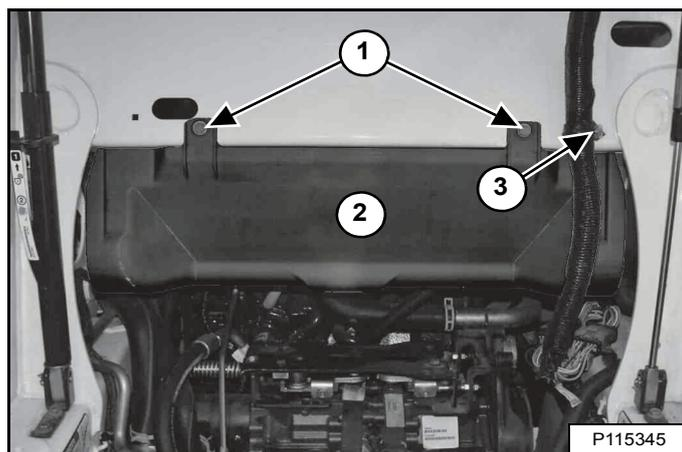
Retirez l'écrou (3) qui retient la bride du faisceau électrique de la cabine et amenez le faisceau vers l'avant de la chargeuse. Déposez les écrous (1) et la gaine inférieure du ventilateur (2) [Figure 291].
