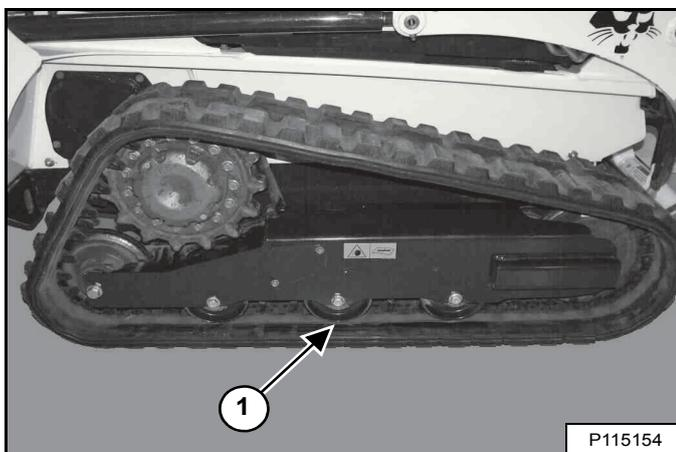
Levez un côté de la chargeuse et placez des chandelles sous les coins avant et arrière du châssis de façon à ce que la chenille soit décollée du sol d'environ 76 mm (3") [Figure 274]. Abaissez la chargeuse sur les chandelles. Évitez tout contact entre les chandelles et la chenille.
