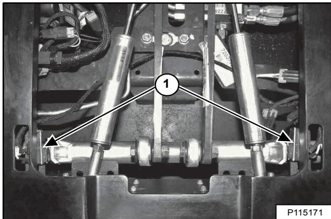
Les contacteurs de l'alarme de recul (1) [Figure 181] sont situés contre les leviers de direction. Les deux contacteurs doivent être correctement réglés pour que l'alarme de recul fonctionne convenablement.
