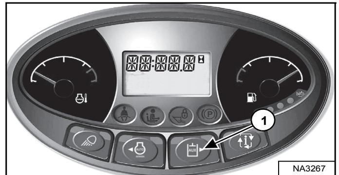
Appuyez sur le bouton du circuit hydraulique auxiliaire (1) [Figure 99].
