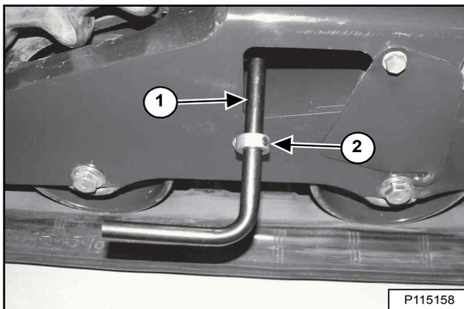
Installez l'outil purgeur (7277225) (1) sur le raccord de tension des chenilles, réglez et serrez le collier (2) [Figure 283] de sorte qu'il se place derrière le bord du capot d'accès (côté droit illustré).
