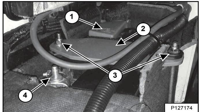
Branchez le câble positif (+) (1) [Figure 254]. Serrez les écrous à un couple de 5,4 à 6,8 Nm (4 à 5 ft-lb).
