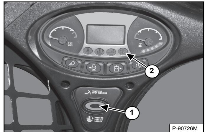
(Fonctionne uniquement lorsque l'arceau de siège est relevé et que le moteur tourne) La commande de déverrouillage de la transmission (TRACTION LOCK OVERRIDE) (1) [Figure 39] se trouve sur le tableau de bord gauche. Elle permet de déplacer la chargeuse en marche avant ou arrière à l'aide des commandes de direction en cas d'utilisation de la pelle rétro.
