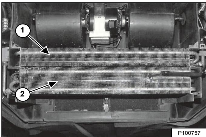
Nettoyez le faisceau de chauffage (1) et d'évaporation (2) avec de l'eau ou de l'air à basse pression pour retirer tous les débris [Figure 198].
