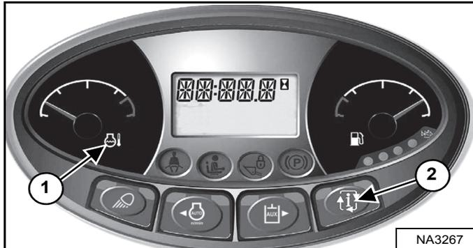
Contrôlez régulièrement les cadrans de température et de niveau de carburant ainsi que les témoins BICS™ (tous doivent être ÉTEINTS pour utiliser la chargeuse) [Figure 133].
