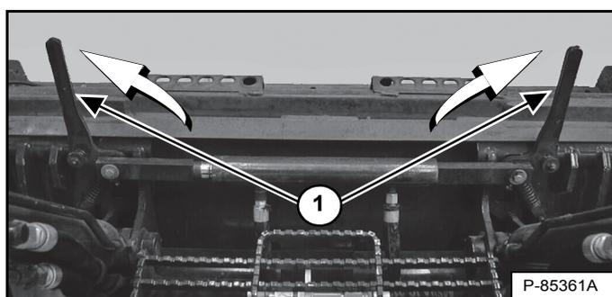
Appuyez sur le côté UP du contacteur BOB-TACH WEDGES (Montée des cales) (panneau des contacteurs droit) et maintenez-le enfoncé [Figure 145] jusqu'à ce que les leviers (1) [Figure 146] soient complètement relevés (cales entièrement levées).
