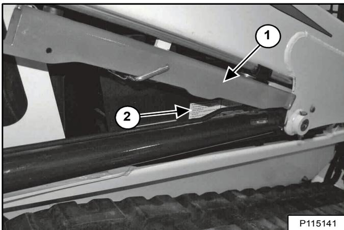
L'arrêt de bras de levage (1) [Figure 172] sert à maintenir les bras de levage pour travailler sur une machine dont les bras sont relevés.
