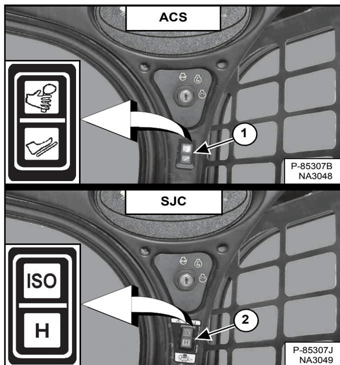
(ACS) Sélectionnez le fonctionnement par commandes manuelles ou par pédales (1) [Figure 120] si la machine est équipée de commandes ACS.
