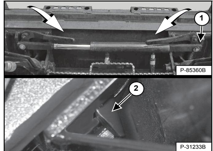
Appuyez sur le côté DOWN du contacteur BOB-TACH WEDGES (Descente des cales) (panneau des contacteurs droit) et maintenez-le enfoncé jusqu'à ce que les leviers [Figure 150] soient complètement engagés en position verrouillée [Figure 151] (les cales dépassent des orifices du châssis de fixation de l'accessoire).
