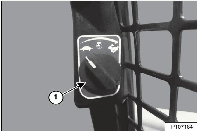
La commande d'accélérateur (1) [Figure 40] se trouve sur le montant de la porte, sous le tableau de bord droit.
