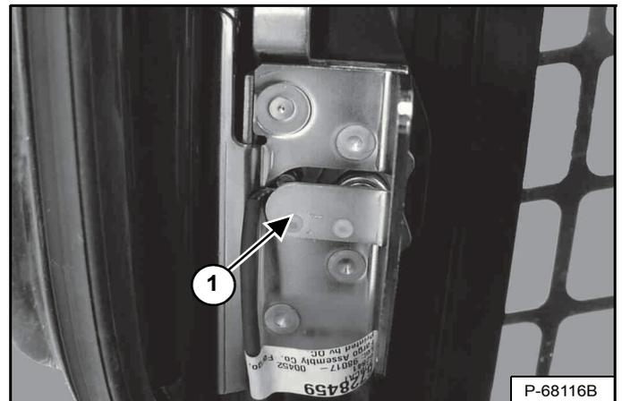
La porte de cabine est équipée d'un capteur (1) [Figure 183] qui désactive les fonctions de levage et de cavage lorsque la porte est ouverte.
