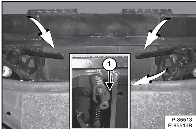
Abaissez les leviers du Bob-Tach jusqu'à ce qu'ils soient complètement verrouillés [Figure 141] (cales complètement engagées dans les orifices du châssis de fixation de l'accessoire).
