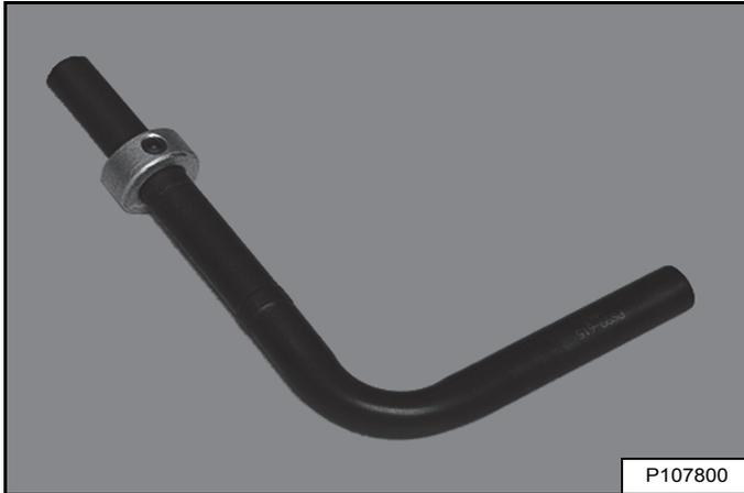
Un outil purgeur **[Figure 273]** est disponible et recommandé pour réduire la tension des chenilles. L'outil purgeur oriente l'écoulement de la graisse pour faciliter le nettoyage. Consultez votre concessionnaire Bobcat pour commander un outil purgeur.
