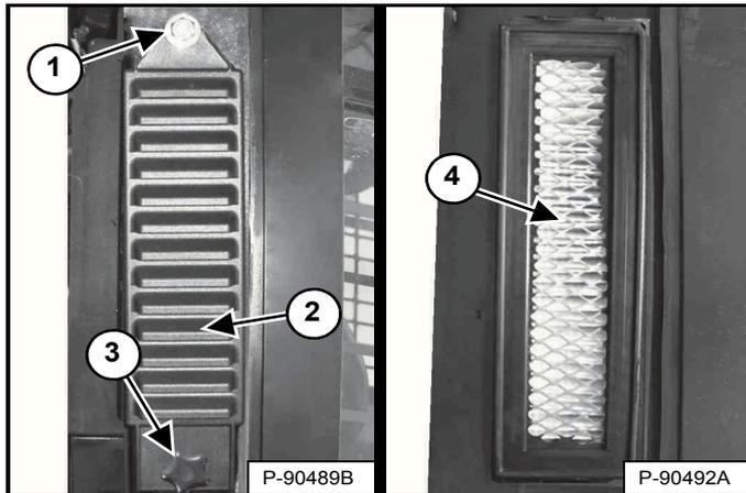
Les filtres d'air frais se trouvent derrière les vitres latérales, à l'extérieur de la cabine (côté droit représenté). Déposez la vis de blocage (3) et le couvercle du filtre (2) [Figure 195]. (Les bras de levage sont représentés levés pour plus de clarté).
