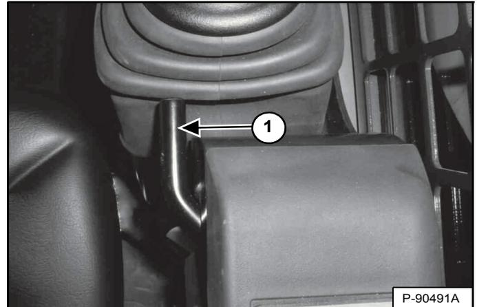
Tirez le levier de réglage (1) [Figure 116] du manipulateur vers le haut pour faire glisser le manipulateur vers l'avant ou l'arrière afin de le placer dans la position la plus confortable (côté droit illustré).
