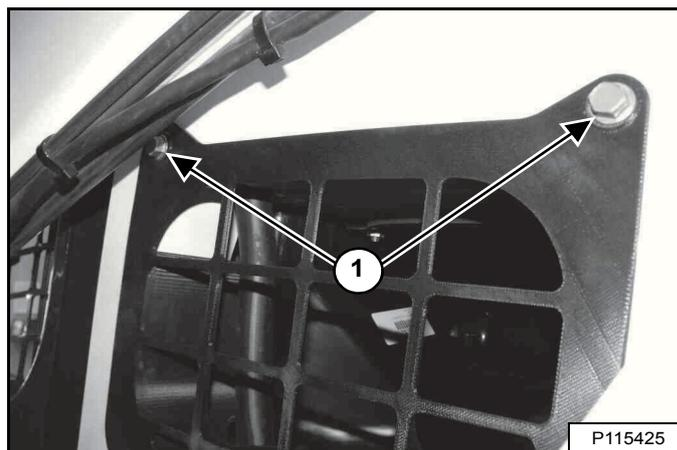
Déposez les boulons (1) du capot d'accès gauche [Figure 292] et retirez le capot.
