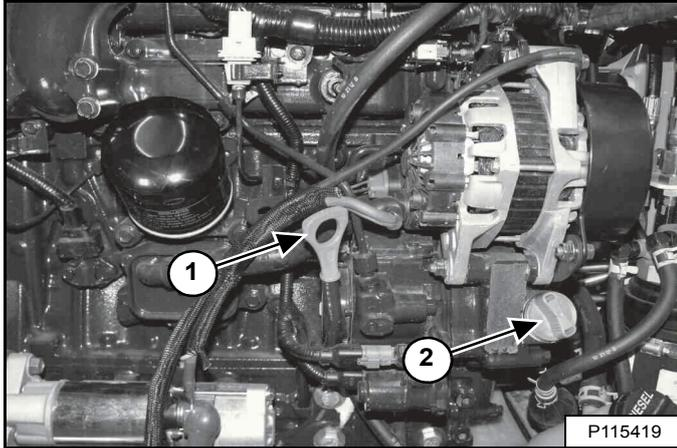
Stationnez la chargeuse sur une surface plane et de niveau. Arrêtez le moteur. Ouvrez la porte arrière et tirez la jauge (1) [Figure 214].
