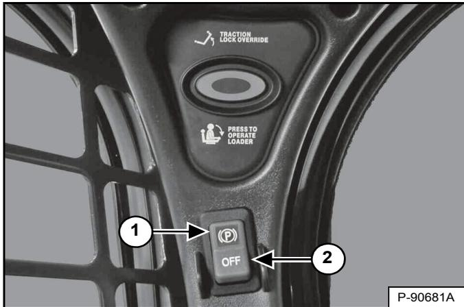
Enclenchez le frein de stationnement en appuyant sur le haut du contacteur (1) [Figure 38]. Le témoin rouge du contacteur s'ALLUME. La transmission est verrouillée.
