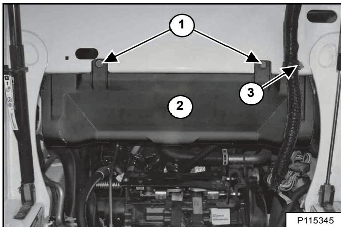
Retirez l'écrou (3) qui retient la bride du faisceau électrique de la cabine et amenez le faisceau vers l'avant de la chargeuse. Déposez les écrous (1) et la gaine inférieure du ventilateur (2) [Figure 267].
