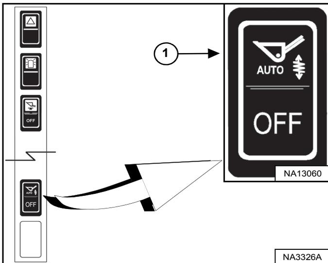
Appuyez sur le haut du contacteur du système antitangage automatique (1) [Figure 86] sur le panneau de contacteurs gauche pour activer la fonction d'antitangage automatique.
