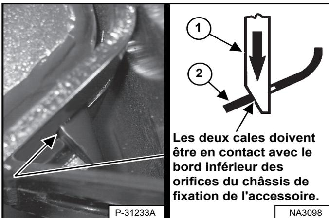
Les cales (1) [Figure 311] doivent dépasser des orifices du châssis de fixation de l'accessoire.
