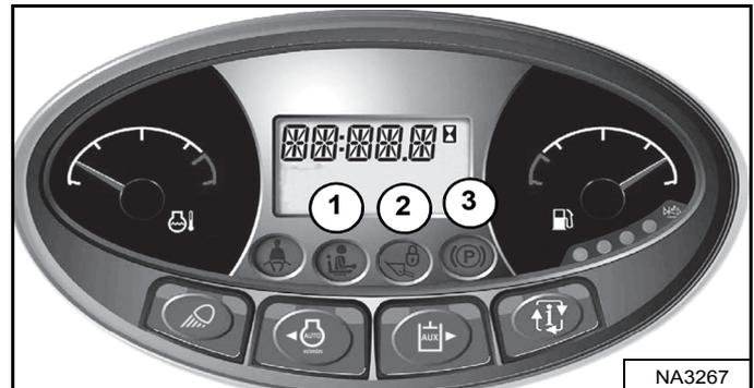
Les trois témoins (1, 2 et 3) [Figure 36] du tableau de bord gauche doivent être ÉTEINTS pour pouvoir utiliser la machine avec toutes ses fonctions.
