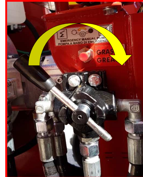
Afbeelding 25: hendel handpomp op stand herstel stempelpoten.
