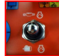
Afbeelding 5: hendeltje voor starten verbrandingsmotor/elektrische motor (*optioneel) op afstandsbediening/draadafstandsbediening.
