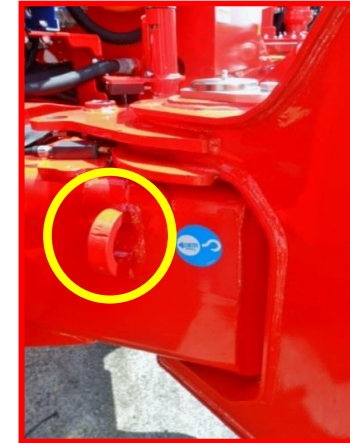
Figure 20 : crochets sur le châssis.
