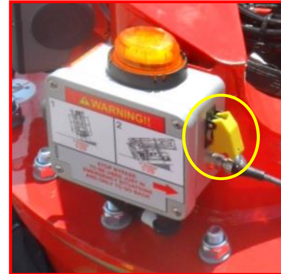
Figure 24 : bouton de by-pass de blocage de translation.
