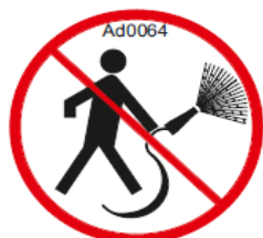
Figure 70 : interdiction de mouiller le composant.
