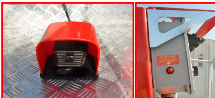
Figure 10 : pédale à action maintenue et côté gauche du boîtier de commande dans nacelle.
