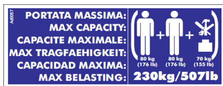
Figure 30 : capacité maximale autorisée dans le panier.
