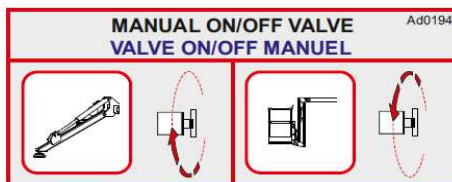
Figure 62 : électrovanne stabilisateurs/partie aérienne.
