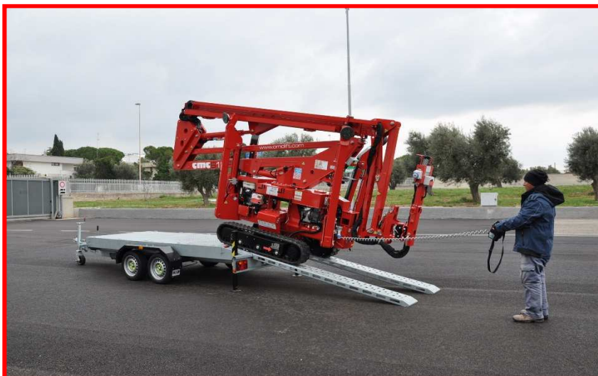
Figure 13 : chargement / déchargement à l'aide d'une rampe.
