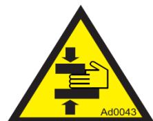
Figure 69 : danger d'écrasement et de cisaillement.
