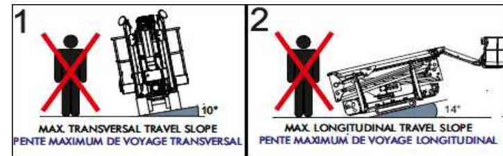
Figure 15 : inclinaisons maximales admises pour la translation.
