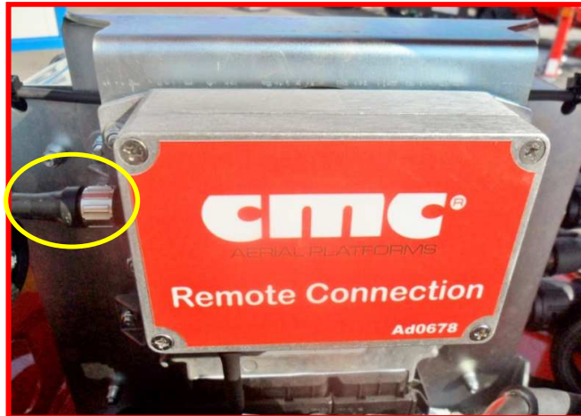
Figure 88 : Boîtier de connexion à distance.
