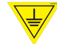
Figure 75 : mise à la terre.
