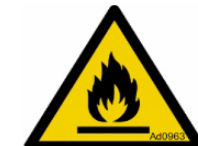
Figure 55 : danger de substances inflammables.
