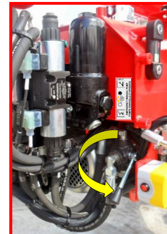
Figure 21 : robinet de la pompe manuelle en position de récupération de partie aérienne
