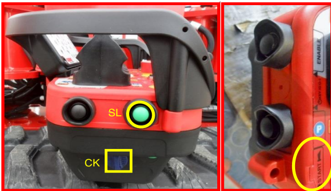
Afbeelding 8a: contactsleutel en knop koppeling afstandsbediening.
