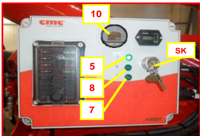
Afbeelding 4b: bedieningspost inschakeling voor lithiumaccu's*.
