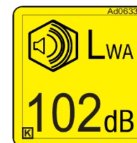
Figure 113 : puissance sonore de la PEMP.
