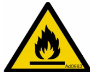
Figure 89 : danger de substances inflammables.
