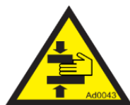
Figure 109 : danger d'écrasement et de cisaillement.
