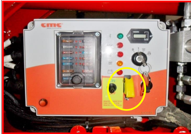
Figure 52 : bouton de by-pass d'urgence.
