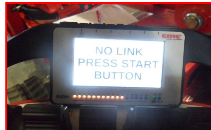
Figure 15 : avertissement de la radiocommande non connectée.
