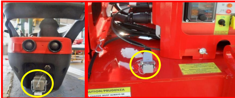
Figure 17 : branchement de la télécommande filaire.
