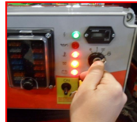
Figure 5 : phase de chauffage des bougies du moteur.
