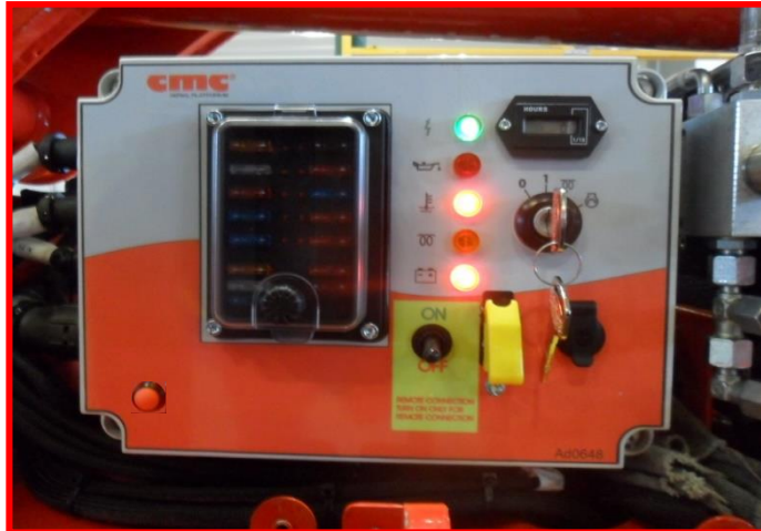
Figure 6 : emplacement de la clé pour allumage du moteur à combustion interne à partir de la radiocommande ou de la console dans la nacelle.
