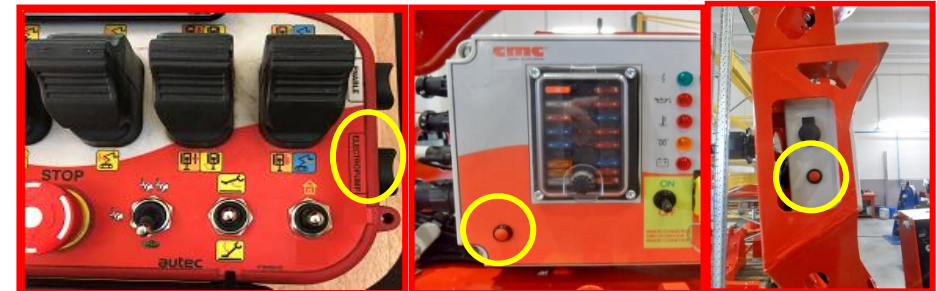
Figure 62 : activation de l'électropompe (*en option).
