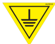
Figure 107 : mise à la terre.
