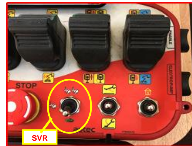
Figure 43 : sélecteur de vitesse sur radiocommande. Pour exécuter une translation en utilisant la radiocommande :
