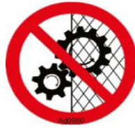
Figure 86 : interdiction de retirer les dispositifs de sécurité.
