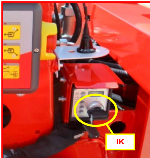
Figure 4 : poste pour marche/arrêt du moteur.
