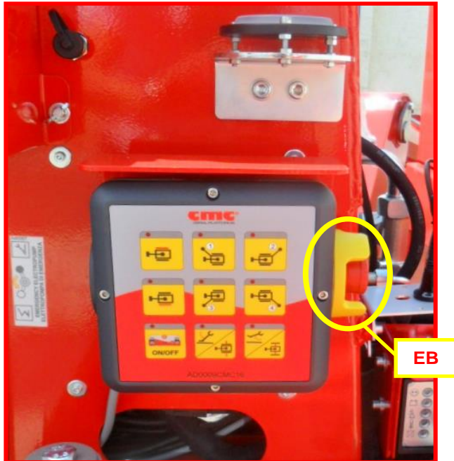
Figure 15 : poste de contrôle stabilisateurs.
