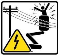
Cette machine **N'EST PAS** isolée électriquement et **NE FOURNIT PAS** de protection en cas de contact ou de proximité avec des lignes électriques. Respecter les distances minimales de sécurité demandées par la réglementation nationale en vigueur ou, en leur absence, se rapporter aux distances minimales indiquées dans le tableau ci-contre (réf. Norme ISO 18893 : 2014).
