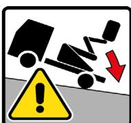
Avant d'utiliser la machine vérifier que le terrain soit en mesure de soutenir le poids de la machine et de résister à la pression des stabilisateurs. La charge maximale est indiquée sur les autocollants présents sur chaque stabilisateur et dans les caractéristiques techniques du manuel.
