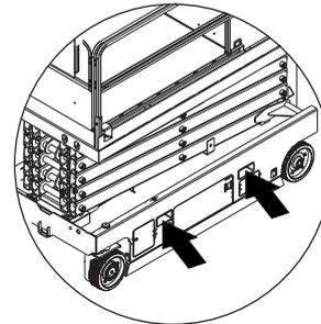
Placer les fourches des chariots élévateurs en position sur les entrées de fourche.
