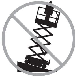
Ne pas relever la nacelle tant que la machine n'est pas sur une surface ferme et plane.
