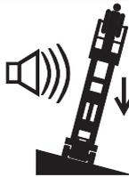
L'écran à DEL des commandes de la nacelle affiche « LL », l'écran à cristaux liquides des commandes au sol affiche « LL: Machine Tilted » (LL : Machine inclinée) et l'alarme de dévers retentit à 180 bips par minute. Fonctions affectées : les fonctions de translation, de direction et d'élévation sont désactivées.
