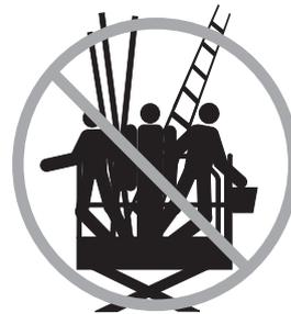
Ne pas placer d'échelle ni d'échafaudage dans la nacelle, ni contre une partie de la machine.
