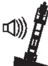
Replacer la machine sur une surface horizontale pour rétablir les fonctions d'élévation.
