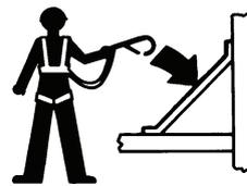
Les occupants de la nacelle doivent porter une sangle ou un harnais de sécurité, conformément aux réglementations officielles. Attacher la longe de sécurité au point d'ancrage prévu à cet effet sur la nacelle.
