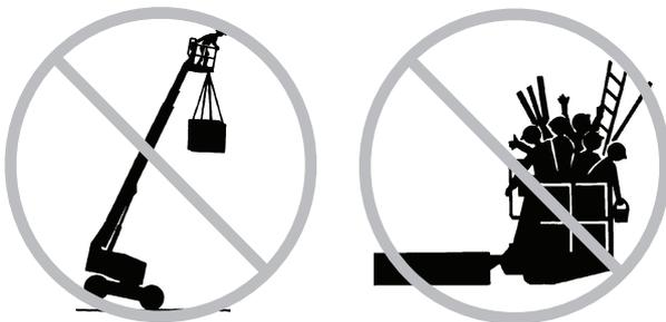
Ne pas placer d'échelle ni d'échafaudage dans la nacelle, ni contre une partie de la machine.
