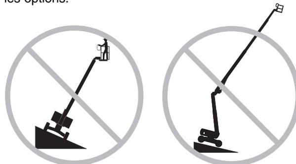
Ne pas lever ni étendre la flèche si la machine n'est pas sur une surface ferme et plane.
