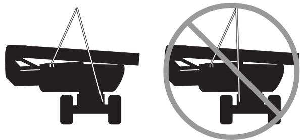
Attacher les éléments d'arrimage aux 2 points de levage du châssis les plus éloignés du point de levage de la tourelle.
