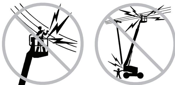
Maintenir une distance de sécurité par rapport aux lignes et aux appareils électriques, conformément aux réglementations officielles et au tableau suivant.
