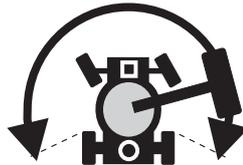
Pour conduire, appuyer sur le bouton de validation de translation et sortir lentement la manette de contrôle de translation/direction de la position centrale.
