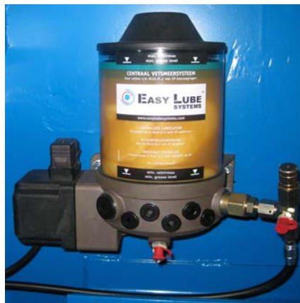
Easy Lube Systems™ réservoir de graisse
