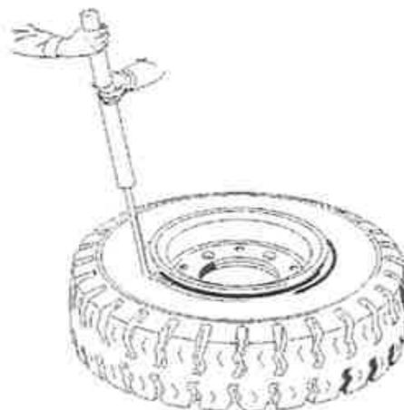
2. Engagez le démonte-pneu dans la fente située entre l'anneau de blocage et la jante. Retirez l'anneau de blocage et le flasque latéral. Enlevez le siège de flasque s'il y en a un.
