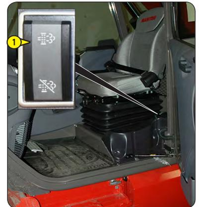
Après la procédure de régénération du filtre à particules d'échappement, laisser le moteur thermique tourner à faible régime pendant quelques minutes pour faire baisser la température avant de couper le contact électrique.
