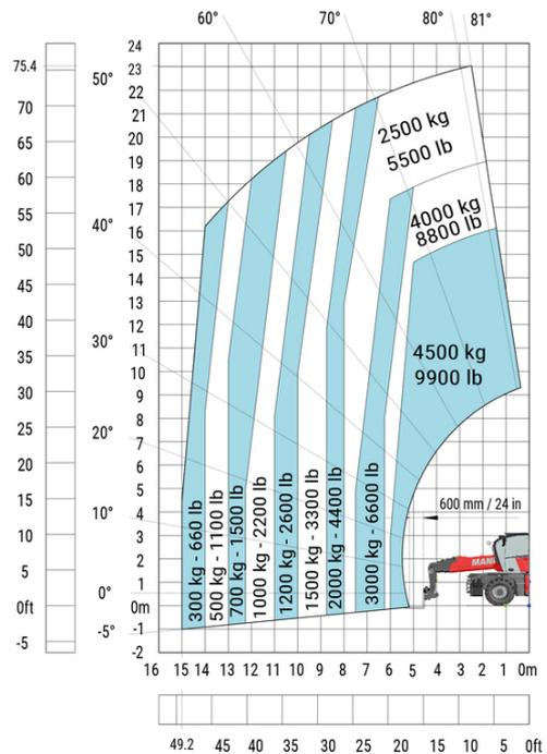
Machine sur stabilisateurs abaissés avec nacelle 1000 kg
