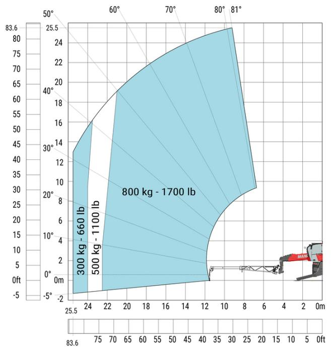
**Machine sur stabilisateurs abaissés avec crochet 6000 kg
