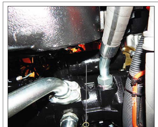
Figure 173: Vérification de la contamination de l'huile hydraulique
