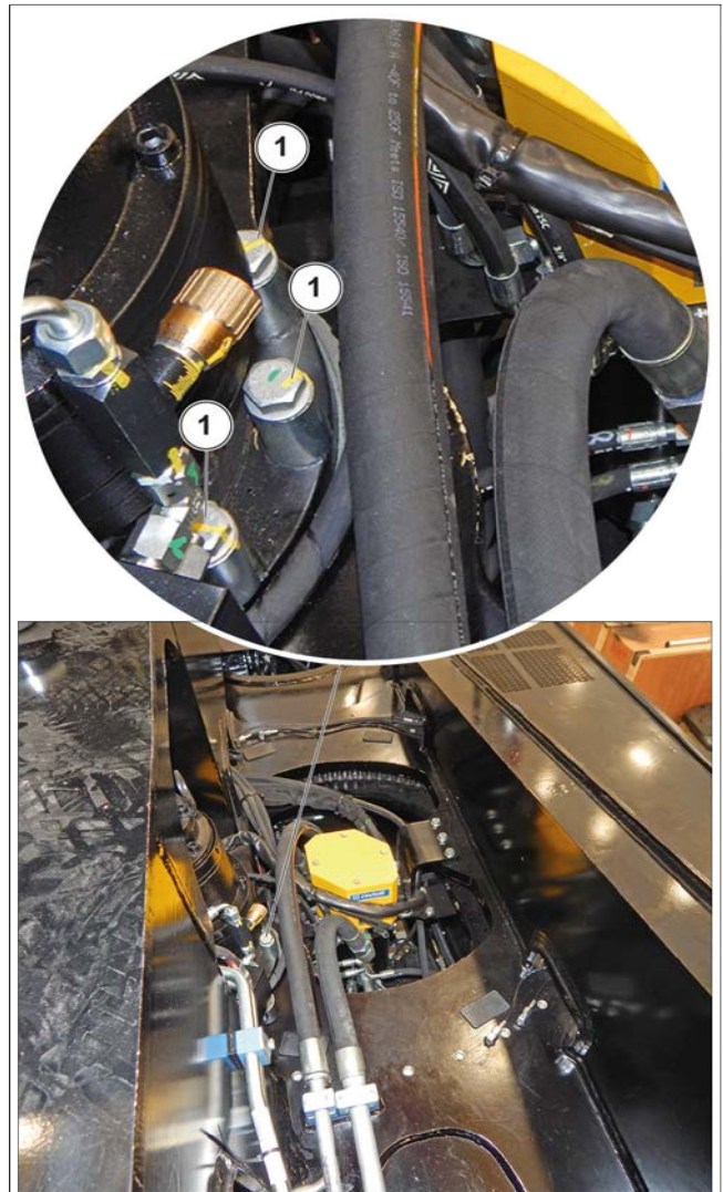
Afbeelding 166: De bevestiging van de bevestigingsschroeven van de rotatiereductor controleren
