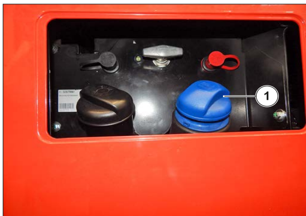
Figure 122: Remplissage du réservoir de DEF
