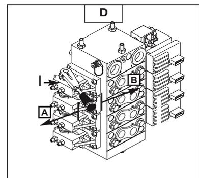
**Pour sortir et rentrer le télescope (positionner le levier sur II).**
