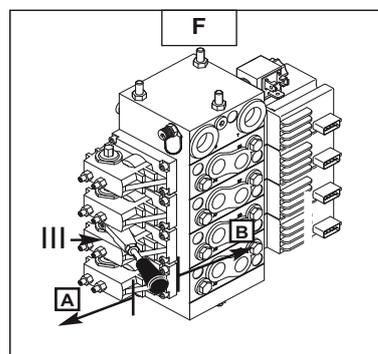
**Pour la rotation de la tourelle ou pour lever ou descendre le pendulaire (positionner le levier sur IV).**
