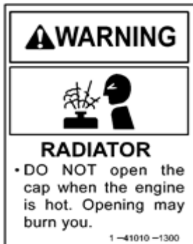
(15) Attention au liquide de refroidissement à température élevée (1-41010-1300)
