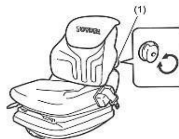
(1) Molette de réglage du support lombaire
