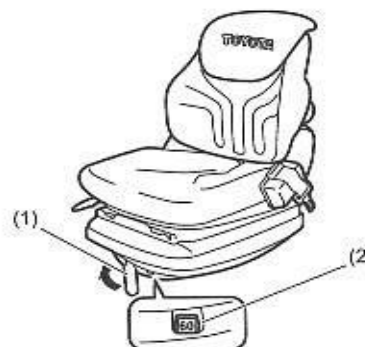
(1) Levier de réglage du poids (2) Indicateur
