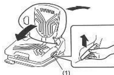
(1) Levier de réglage d'inclinaison du dossier
