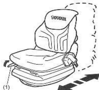
(1) Levier de réglage longitudinal
