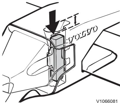
Le dispositif de verrouillage doit se trouver juste en dessous du trait de repère
