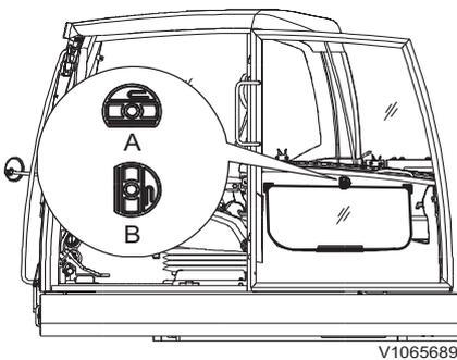
Poignée de verrouillage de fenêtre inférieure
