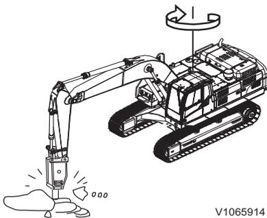
Ne balancez pas le marteau contre les rochers, le béton, etc.
