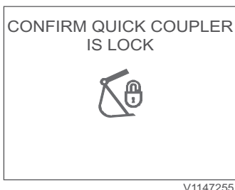
Vergrendeling van snelwissel bevestigen
