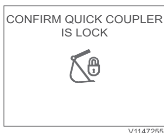
Vergrendeling van snelwissel bevestigen
