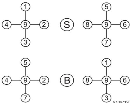
La grille à gauche dans la figure montre les configurations possibles pour le levier de commande gauche.
