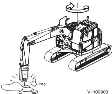
Ne balancez pas le marteau contre les rochers, le béton, etc.
