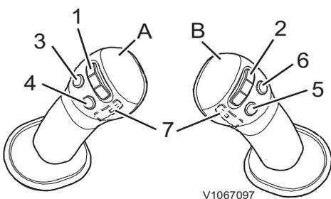
**Leviers de commande à trois boutons et un interrupteur proportionnel**
