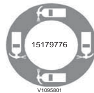
22 Repère des trous pour l'extinction manuelle
