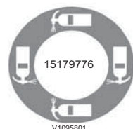
22 Repère des trous pour l'extinction manuelle
