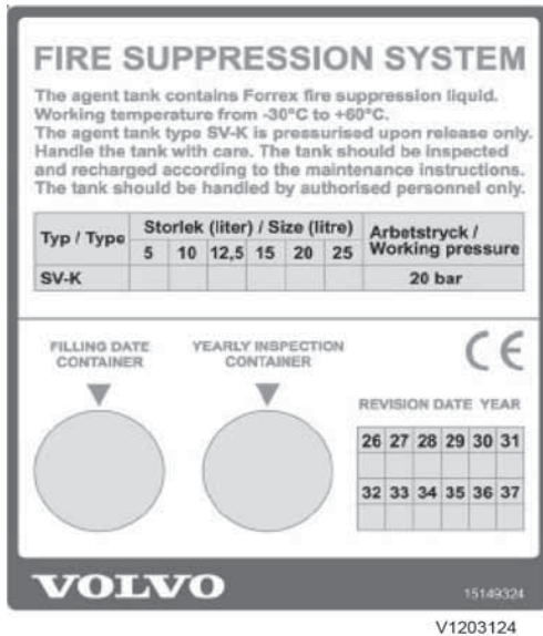
Autocollant d'agent d'extinction (placé sur le réservoir d'agent d'extinction)
