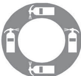
Repère des trous pour l'extinction manuelle
