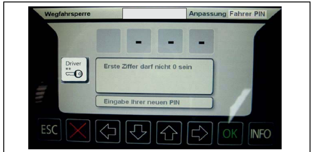
Fig. 5-38 Modification du PIN conducteur après autorisation
