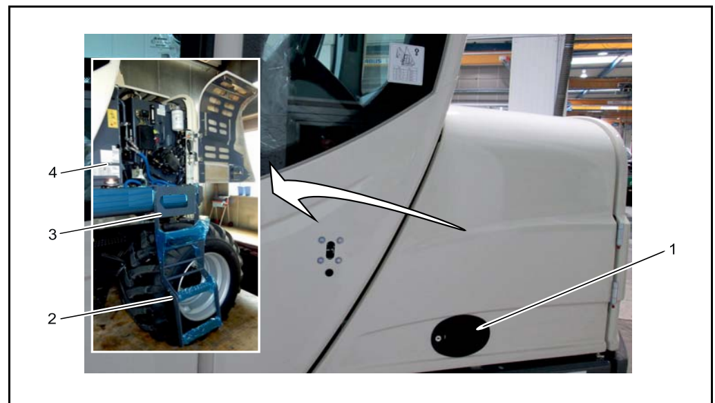
Fig. 6-13 Trappe de maintenance
