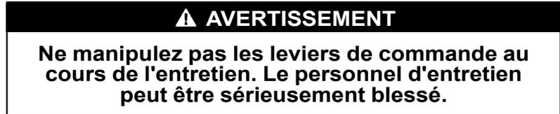
Apposez une étiquette "ENTRETIEN EN COURS" sur la machine ainsi que sur l'un des leviers de commande.
